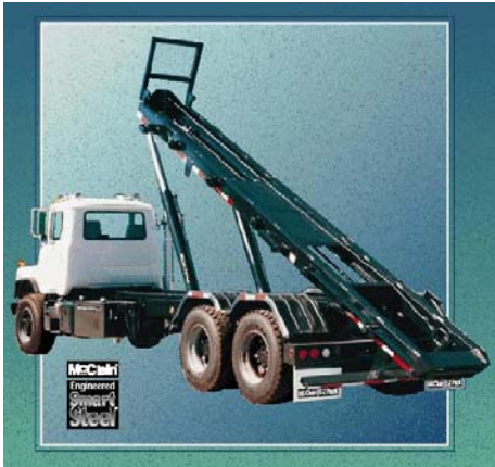
Obr. 6.11 Zberné vozidlá pre veľkokapacitné kontajnery
