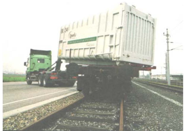
Obr. 7.20 Pohľad na prekladaciu stanicu na železniciu a spôsob nasúvania kontajnera z automobilu na železničný vagón
