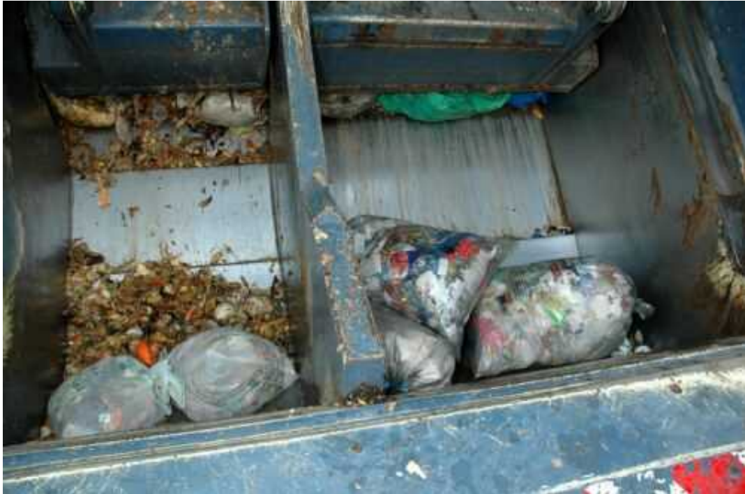
Obr. 6.13 Zberné vozidlo pre dva druhy odpadov
