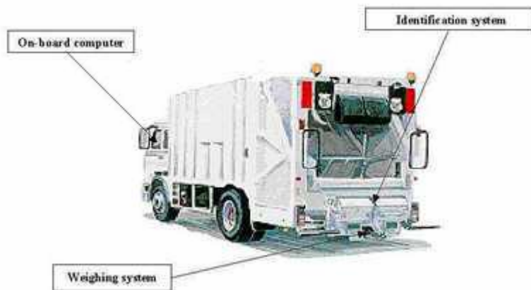
Obr. 6.15 Zberné vozidlo s vážením zbernej nádoby
