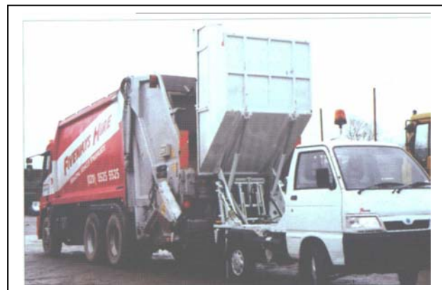
Obr. 6.17 Satelitné vozidlo – a) zber b) vysypanie odpadu do väčšieho vozidla
