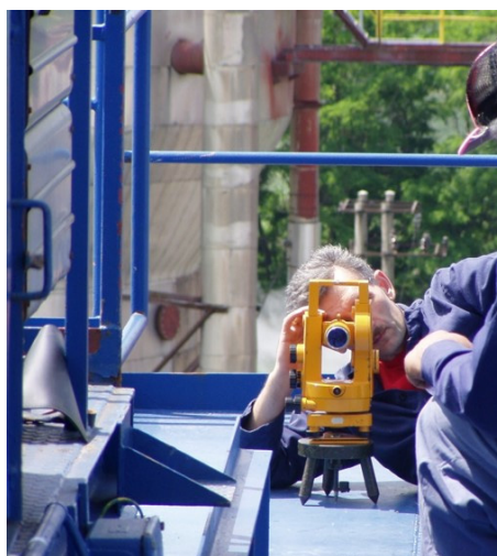
Obr. 7.13. Upevnenie prístroja na pilierovej podložke
