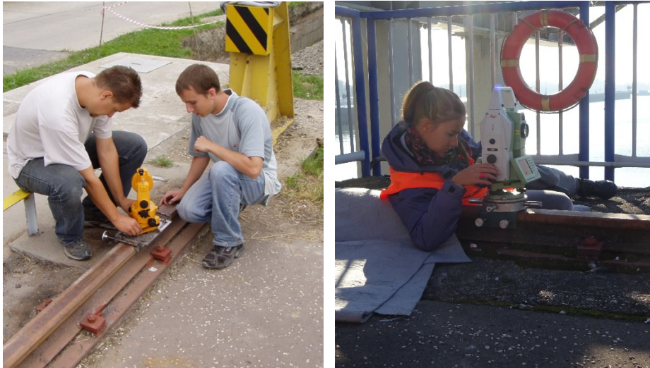
Obr. 7.12. Upevnenie prístroja na špeciálnej podložke
