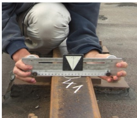
Obr. 7.15. Použitie posuvného meradla s cieľovou značkou
