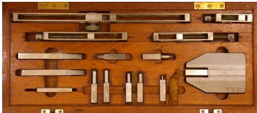
Obr. 4.1. Pravouhlé základné etalóny – Johanssonove hranoly (Kechnie, 2005)
