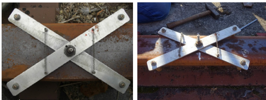
Obr. 7.11. Poliace nožnice na koľajnicovom pásu
