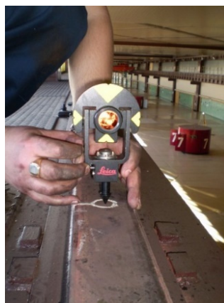
Obr. 7.19. Použitie odrazového hranola na meranie smerového priebehu koľajnicových pásov
