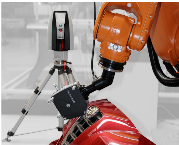
Obr. 6.4. Skenovanie prednej masky auta pomocou skenovacej hlavice (Hexagon, 2015a)
