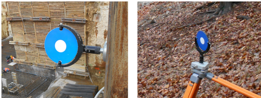
Obr. 5.11. Dočasná stabilizácia vličovacích bodov
