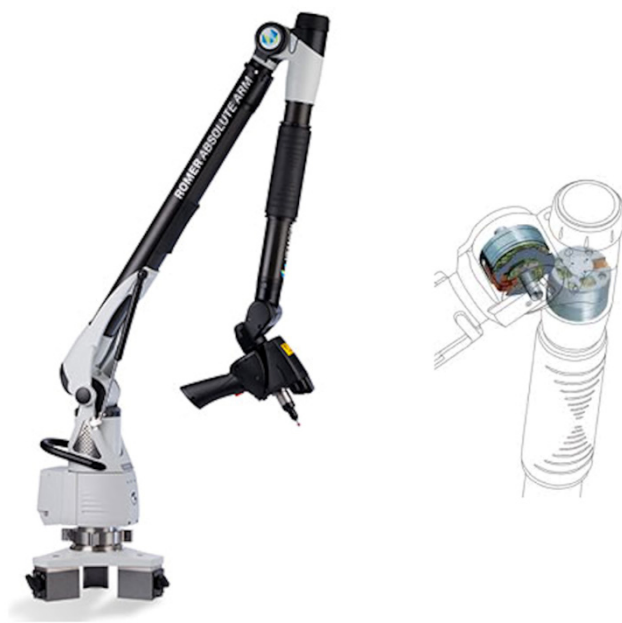
Obr. 6.2. Meracie rameno (vľavo) a uhlomerne snímače zabudované v kĺbových mechanizmoch (vpravo) (Hexagon, 2015b)
