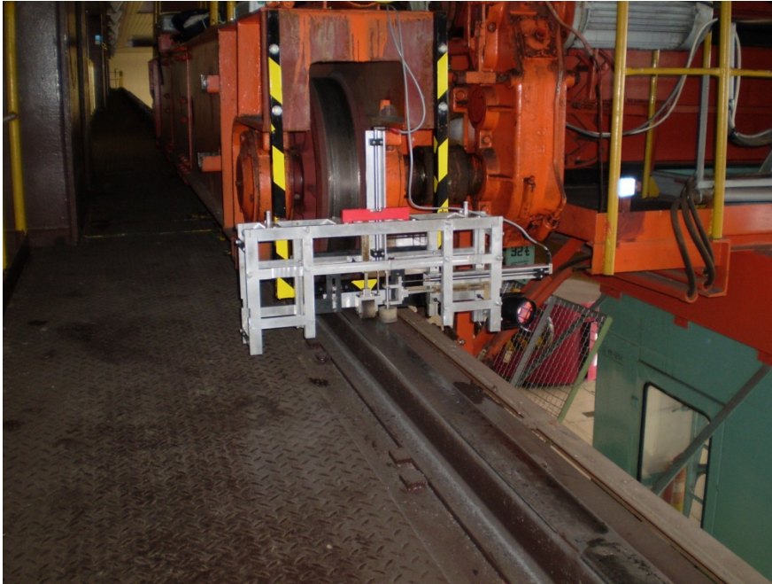
Obr. 7.25. Rám so snímačmi a odrazovými hranolmi upevnený na mostovom žeriave (Kyrinovič, 2011)
