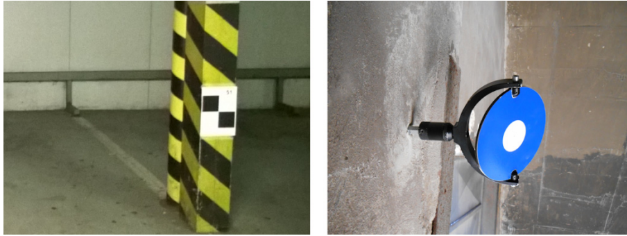
Obr. 5.12. Stabilizácia vlicovacích bodov vo forme samolepiaceho papiera (vľavo) a pomocou kovovej kotvy v betónovom podklade (vpravo)
