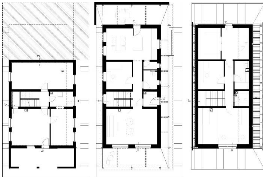
Uplatnenie princípu kompaktnej dispozície na realizovanom diele
