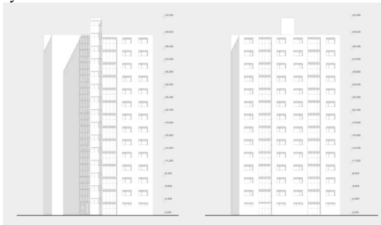
Obrázok 8 Pohľady na bytový dom ZTB – 13 B – návrh s nárazníkovými zónami v polohe loggií (Zdroj: Ruhig, 2019)
