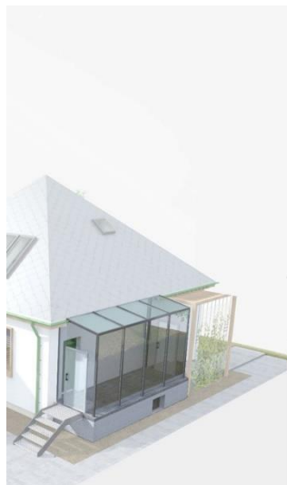
Obrázok 5 Variant C – zachovanie čelnej steny, transparentný strop (Zdroj: Ruhig, Kiabová 2017)
