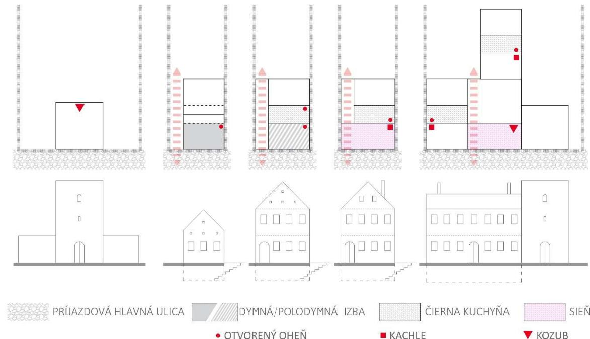
Obr. 5.1: Vývojové etapy meštianskeho domu z hľadiska dispozície a z hľadiska možnej polohy výhrevného telesa. Zlava: Vežový dom, Komorový dom, Dom s prejazdom, Sieňový dom a zrkadlenie typologického trojpriestoru vzájomným prepájaním (Zdroj: E. Ruhigová)
