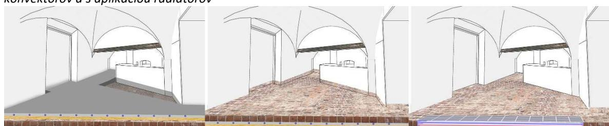
Obr. 8.11: Schematický vizuál čiernej kuchyne s aplikáciou nízkoteplotného vykurovania (reverzibilná podlaha), s inštalácia nových vrstiev pod pôvodnú podlahu a s aplikáciou podlahových konvektorov
