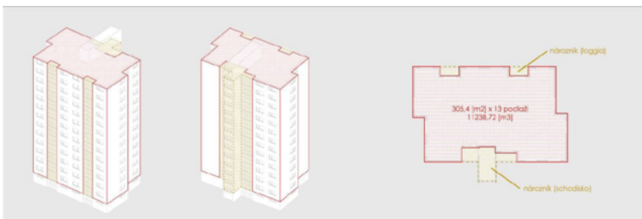
Obrázok 3: Vytýčenie vykurovaného objemu s integrovaním zasklených loggií ako nárazníkových zón
