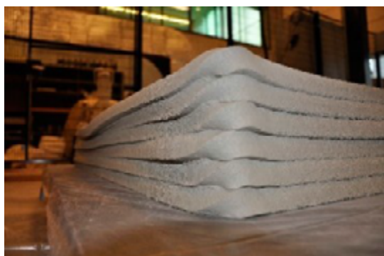
Obr. 5: Krútenie tlačenej zmesi na rohoch tlačenej konštrukcie [1]
