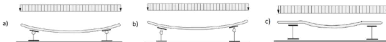
Obr. 1: a) kľb v úrovni skleného panela, b) kľb mimo skleného panela, c) pevná podpera [2]
