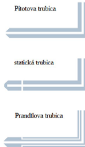
Obr. 3 Prandtlova trubica a schéma rozdielov medzi Pitotovou a Prandtlovou sondou [www.wikipedia.com]
