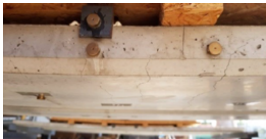
Obrázok 3: rozvoj trhlin v strede rozpätia dosky a nárast priehybu na doske č.1
