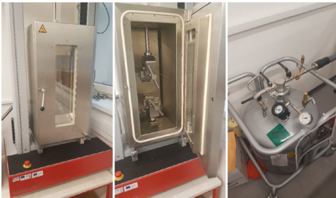
Obr. 5 Trhací prístroj M500-25 CT s klimakomorou TH2700 (vľavo, stred); Nádoba na kvapalnú dusík Cryotherm 50L (vpravo)
