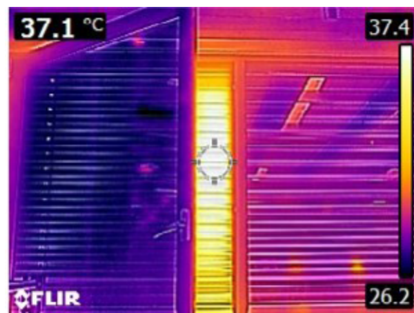
Obr. 2: Tepelný zisk citelným teplom z vonkajšieho prostredia
