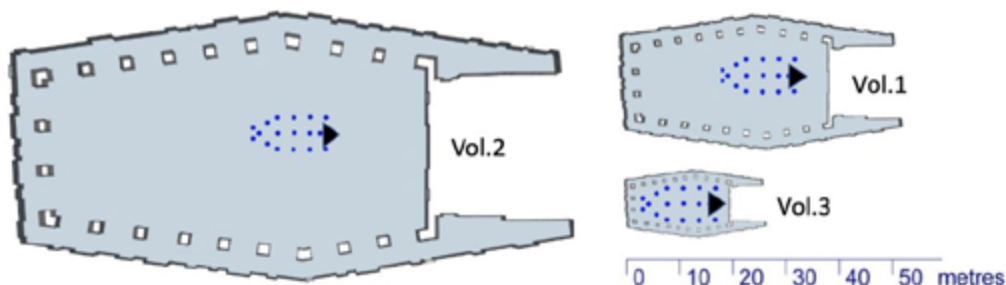
Obrázok 4. Pôdorysný pohľad na 3 átriá v rôznych modelovaných rozmeroch (Objem 1, 2 a 3) so znázorneným umiestnením všesmerového bodového zdroja zvuku (čierny trojuholník) a rozmiestnením prijímačov (modré bodky), v Experimente 1.
