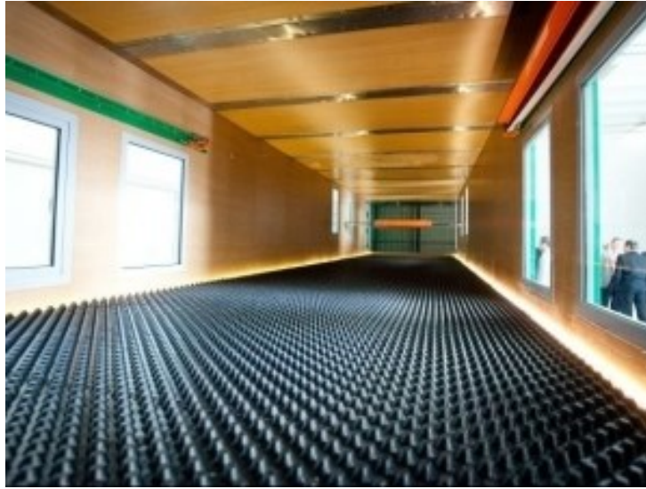
Obr. 3: Zdrsnenie spodnej steny veterného tunela STU pomocou nopovej fólie. Takto zdrsnený povrch radí hraničnú vrstvu, ktorá vznikne do kategórie 3-4.
