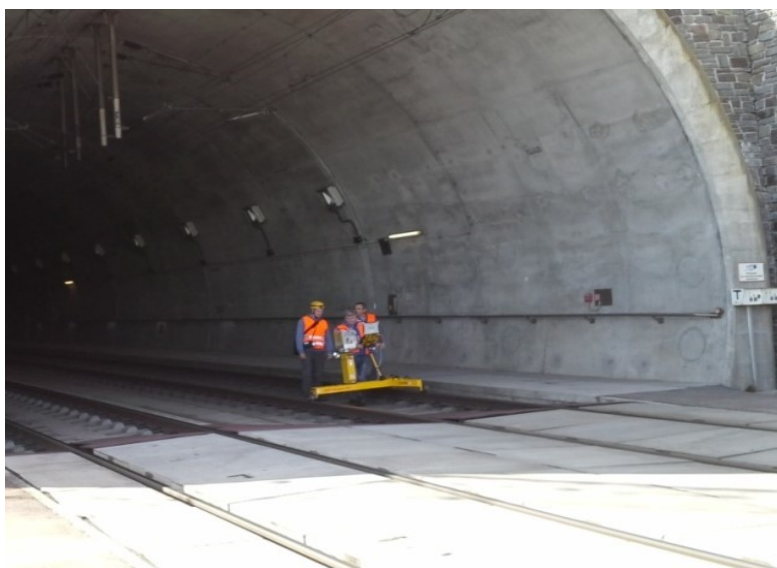
Obrázok 3-1 Použitie systému GRP 5000 na železničnej trati Bratislava- Žilina, úsek Turecký Vrch
