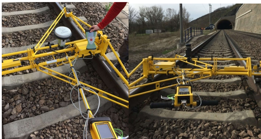
Obrázok 3-4 Ukážka možnosti umiestnenia meracieho systému s anténou GNSS (vľavo) a s 360° aktívnym odrazovým hranolom UMS (vpravo)
