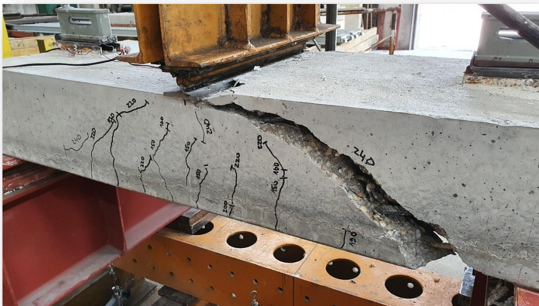
Obr. 4.2 Porušenie vzorky S1 – zadná strana
