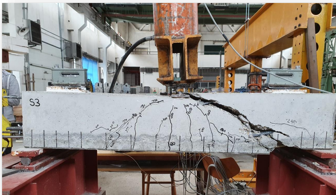
Obr. 4.10 Porušenie prvku S3 – predná strana
