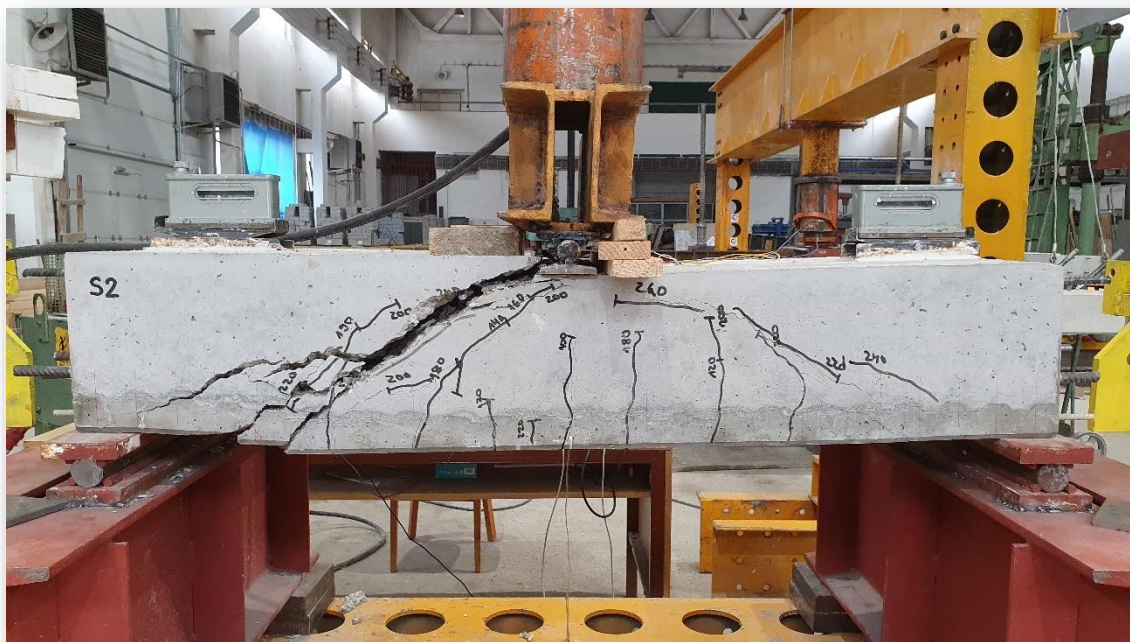
Obr. 4.6 Porušenie prvku S2 – predná strana
