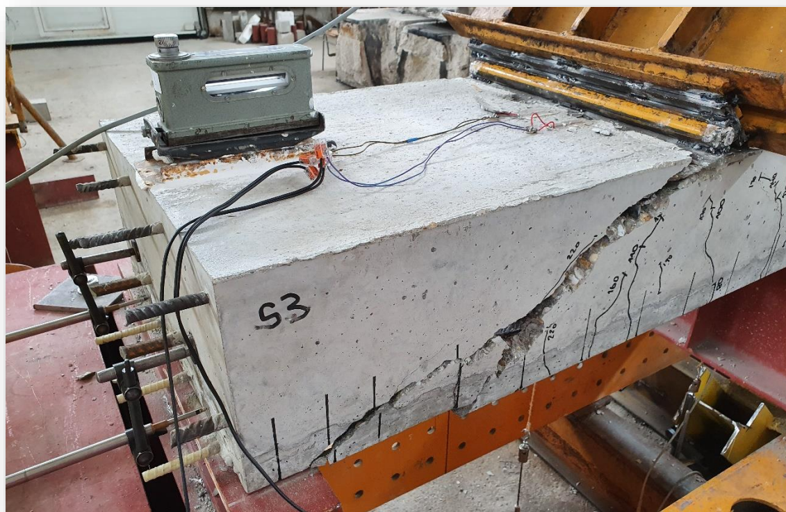
Obr. 4.11 Porušenie prvku S3 – zadná strana
