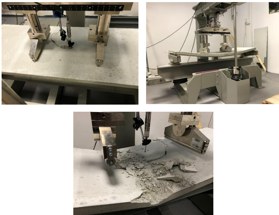
Obr. 1.5 Experimentálne nastavenie zostavy a porušenie prvku SBD-I [42]
