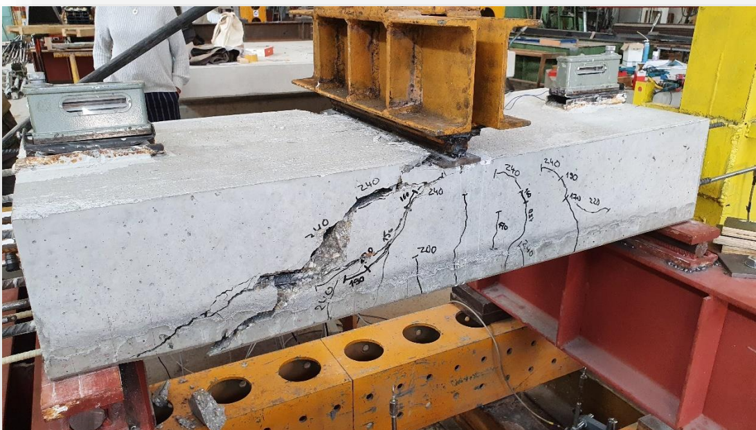
Obr. 4.3 Porušenie vzorky S1 – predná strana
