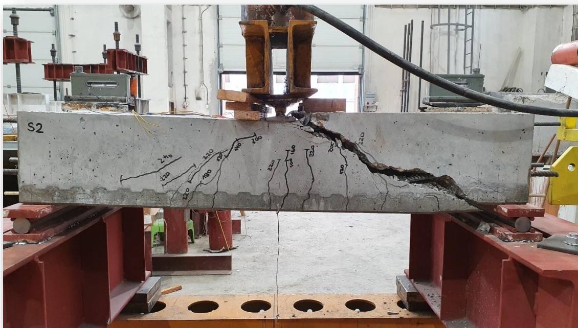
Obr. 4.7 Porušenie prvku S2 – zadná strana
