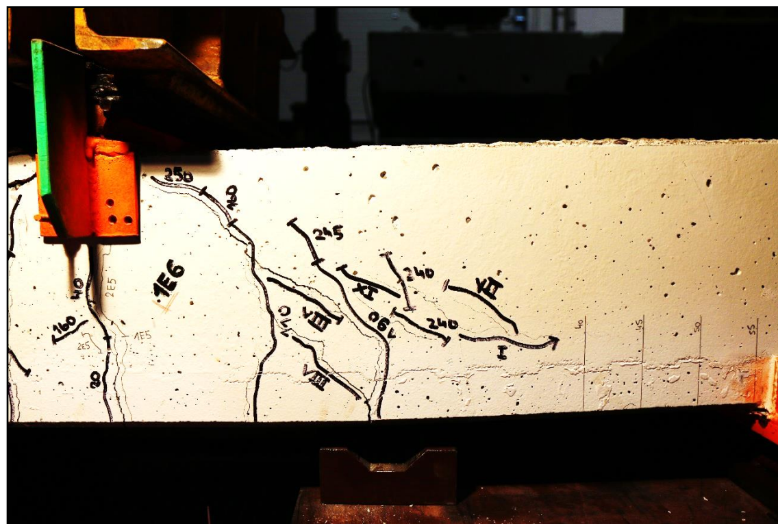
Obr. 4.28 Porušenie D1 – vpredu vpravo
