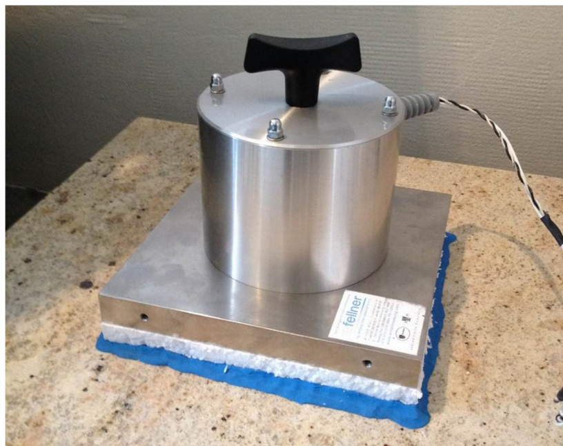
Obr. 4 Pohľad na skúšanú vzorku (EPS) pod zaťažovacou doskou počas merania jej dynamickej tuhosti, systém DYPs
