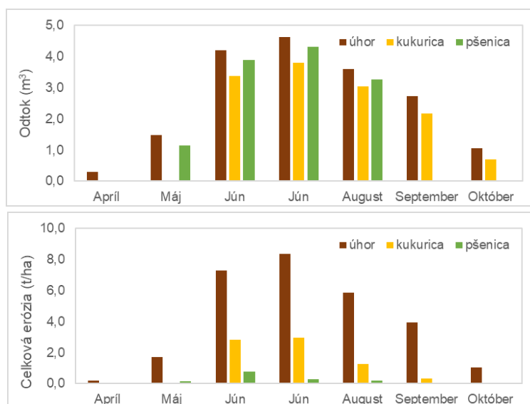
Obr. č. 4 Vplyv vegetačného obdobia na odtokové a erózne procesy – príklad pre 100-ročnú zrážku obdobie „minulosť“ (1981-2010), vlhkosťný scenár 45 % a tri typy pôdneho pokryvu.
