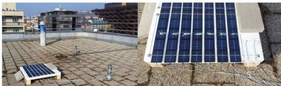
Obr. 6.1 Umiestnenie lamiel a teplotných snímačov počas kalibračného merania.
