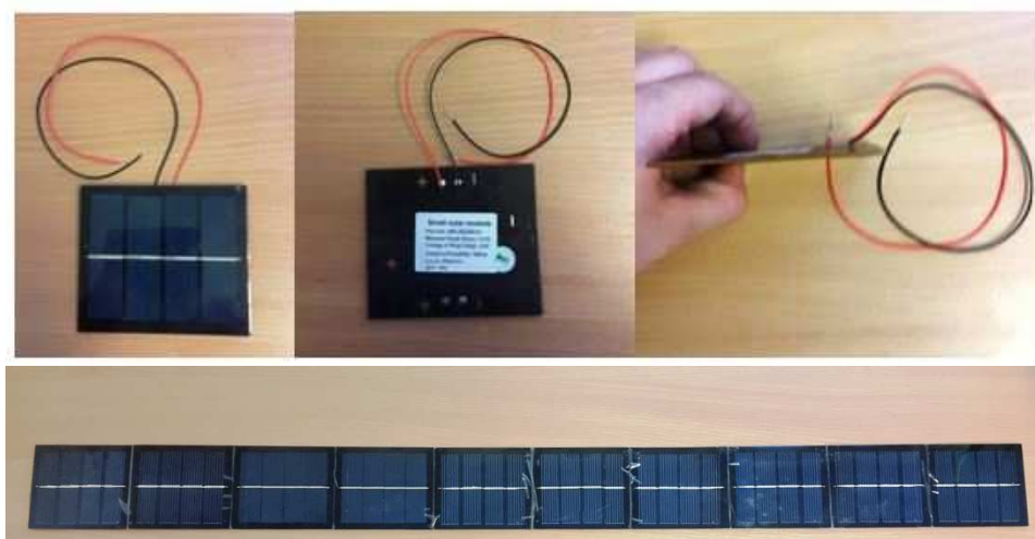
Obr. 5.2 Tenkovrstvový FV modul a FV časť modelu tieniacej lamely.
