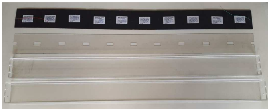
Obr. 5.4 Podkladový profil pre FV lamelu a zásobníky vytvorené z plexiskla.
