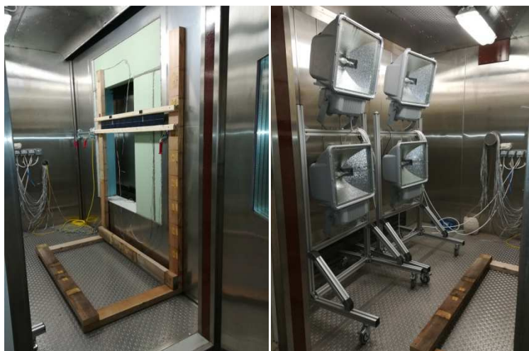
Obr. 8.1 Osadenie meracieho rámu a FV lamiel v klimatickej komore.
