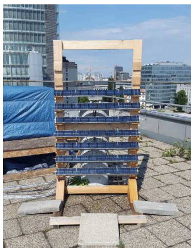
Obr. 7.1 Meranie v mesiaci jún, pri sklone lamiel 30°, prvý merací deň: 10.06.2016.
