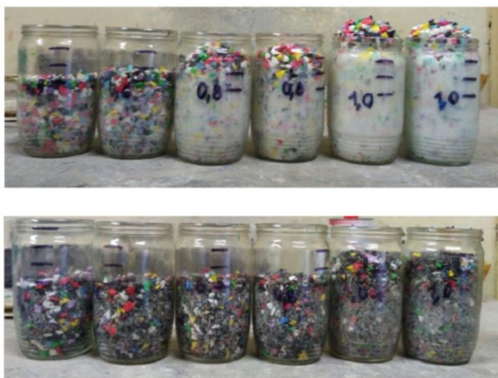
Obr. 2.7 – Výsledky obj. expanzie – hore EVA, dole kombinácia EVA/PVC [5]
