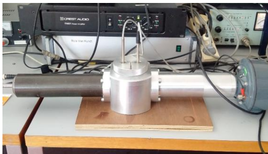
Obr. 2.6 – Kundtova impedančná trubica [autor]
