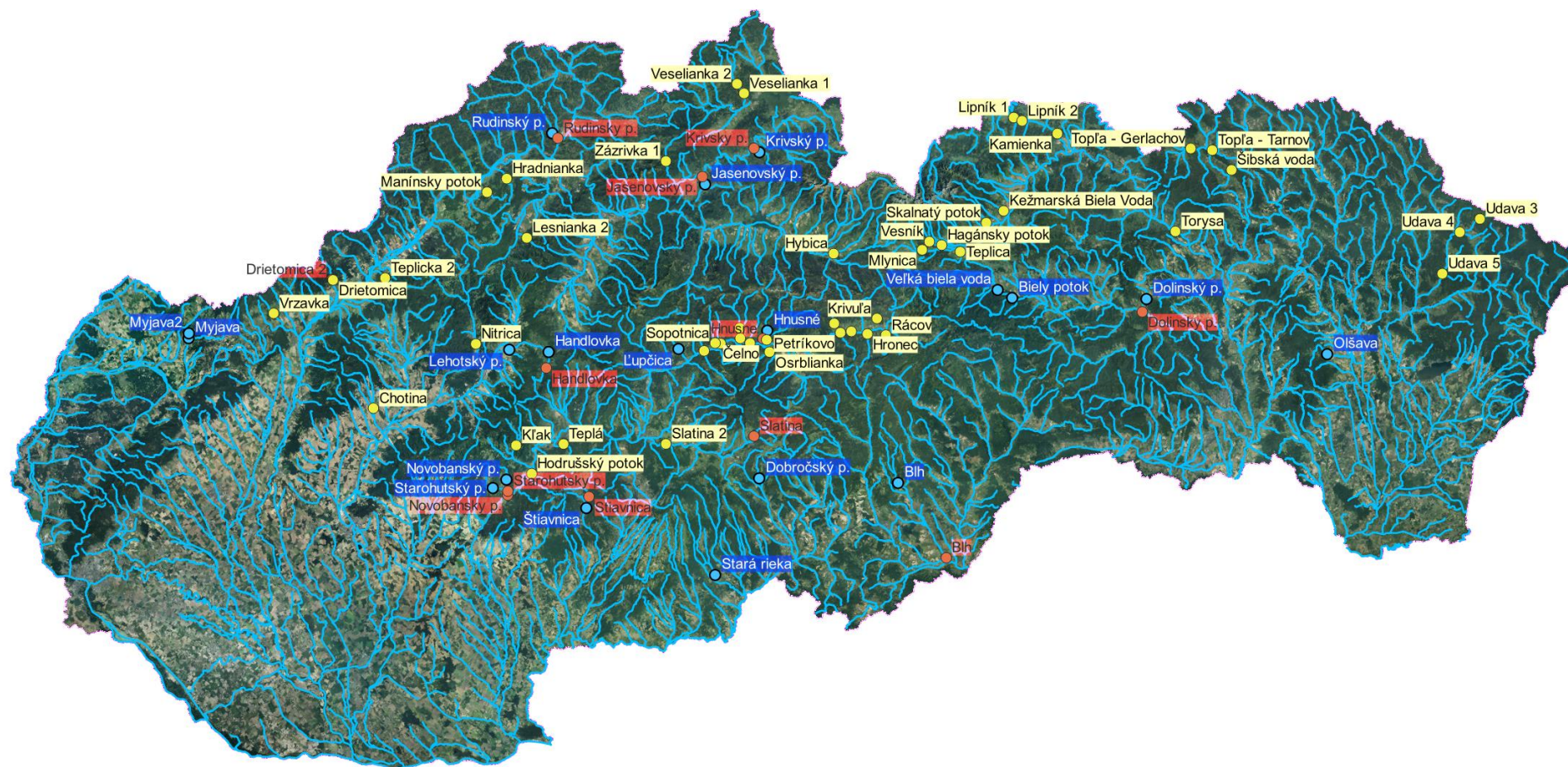
Obrázok 3 Mapa záujmových úsekov tokov použitých pri analýze (žlté - kalibračné dáta Tab.1, modré - testovacie prirodzené Tab.2, červené - testovacie upravené úseky tokov Tab.3) zobrazené na riečnej sieti Slovenska (QGIS)
