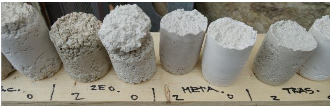
Obrázok 7 Vzorky odobraté počas konzervácie muriva, pripravené na testovanie, 2020. foto: autor
