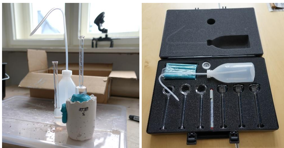
Obrázok 6: Test nasiakavosti za pomoci Karstenovej trubice, 2020. foto: autor
