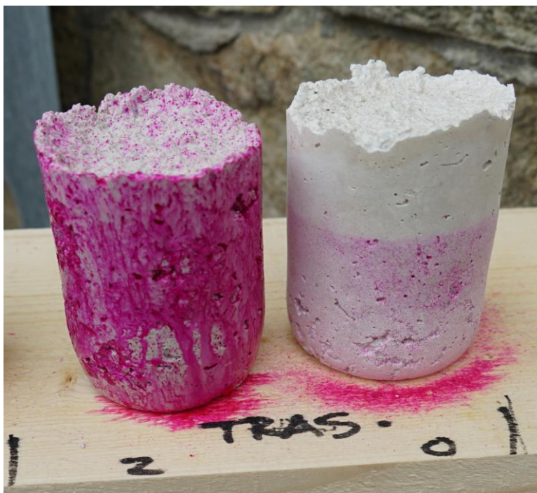
Obrázok 8 Vápenná malta s trasom analýza priebehu karbonatácie. Otvorená vzorka mohla karbonatovať za prístupu vzdušného \text{CO}_2 a vlhkosti do polovice výšky vzorky. Zatvorená vzorka karbonatovala iba na povrchu v kontakte s malou zásobou vzduchu a vzdušného \text{CO}_2 a vlhkosti po vybratí z obalu vykazovala zvýšené PH na čo poukazuje sfarbenie acidobázickým činidlom. Tento princíp sa opakuje pri všetkých testovaných vzorkách. Na vzorke „0 - otvorená“ je zároveň vidieť presné rozhranie čela karbonatácie.
