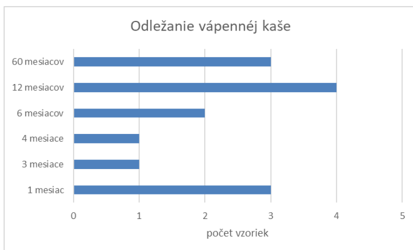
Graf 4 Odležanie vápenej kaše pri sledovaných vzorkách v mesiacoch
