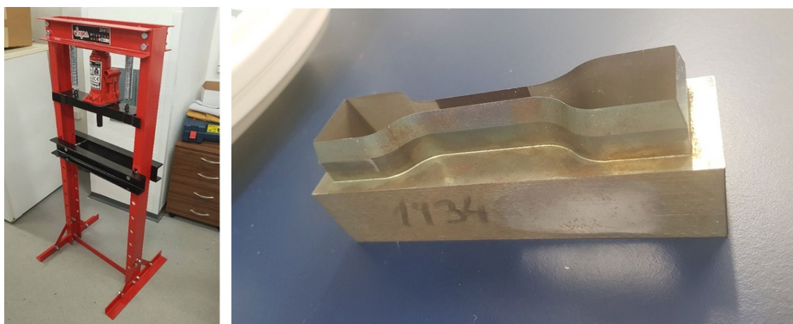
Obr. 8 Ručný hydraulický lis (vľavo), oceľová raznica (vpravo)
