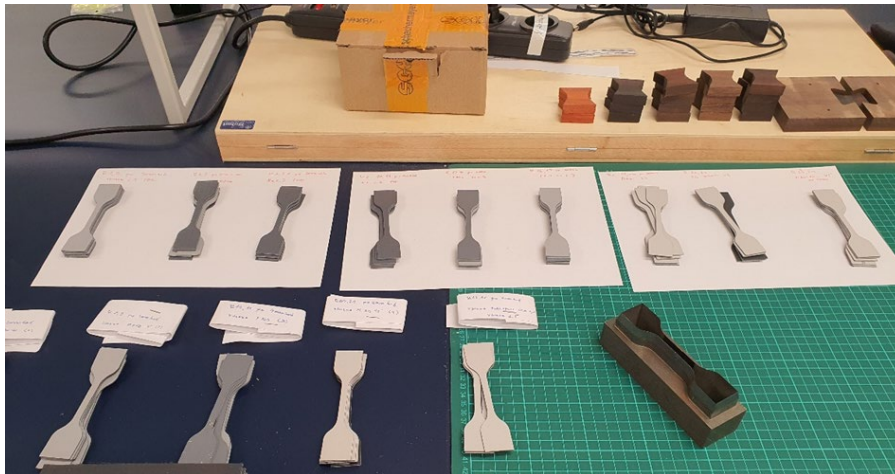
Obr. 12 Príprava vzoriek pre pevnostnú skúšku
