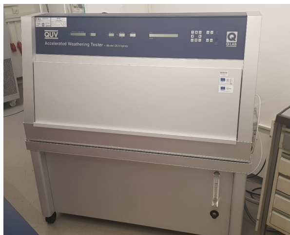
Obr. 10 Prístroj QUV/spray, princíp fungovania prístroja
