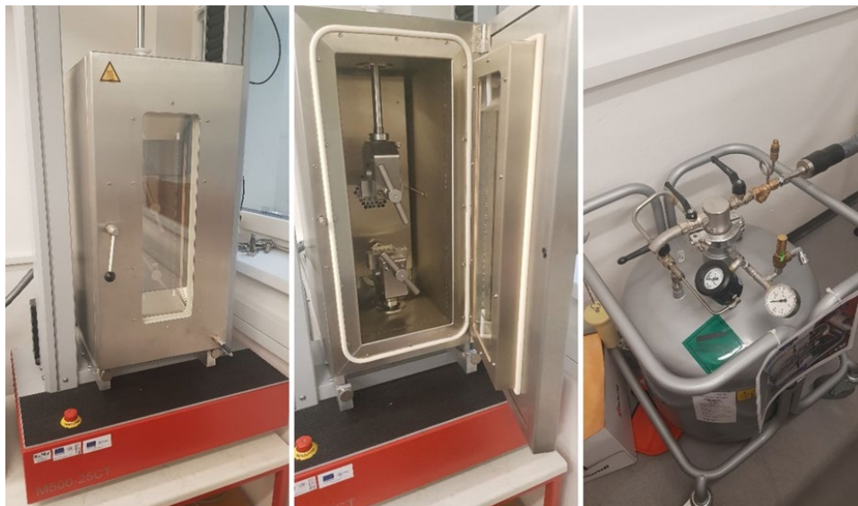
Obr. 9 Trhací prístroj M500-25 CT s klimakomorou TH2700 (vľavo, stred); Nádoba na kvapalný dusík Cryotherm 50L (vpravo)
