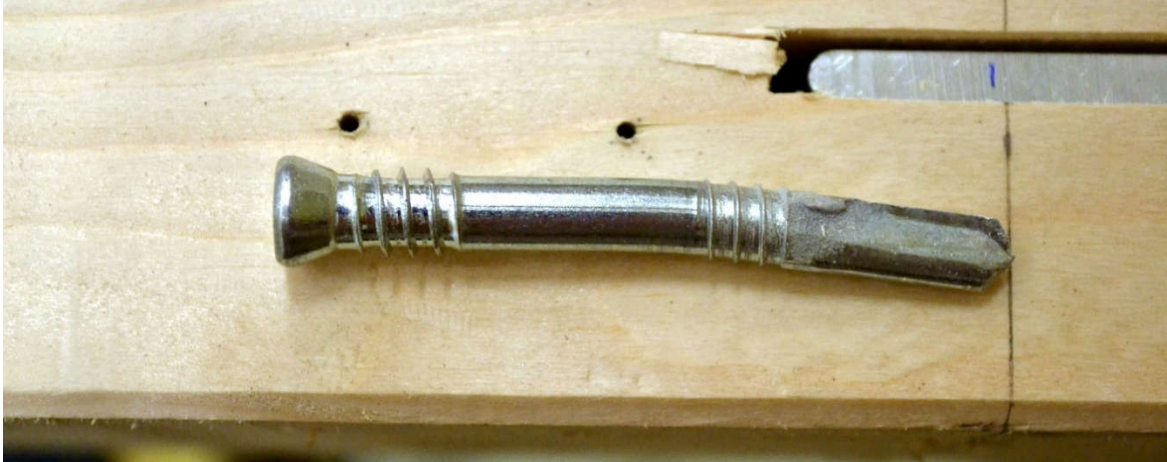
Obr. 4.1 Samorezný kolík SBD po zdeformovaní
