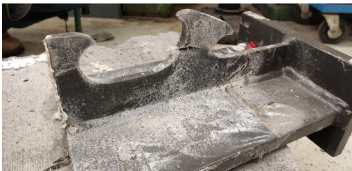
Obrázok 15: Porušenie ocelového šmykového konektora v mieste drieku
