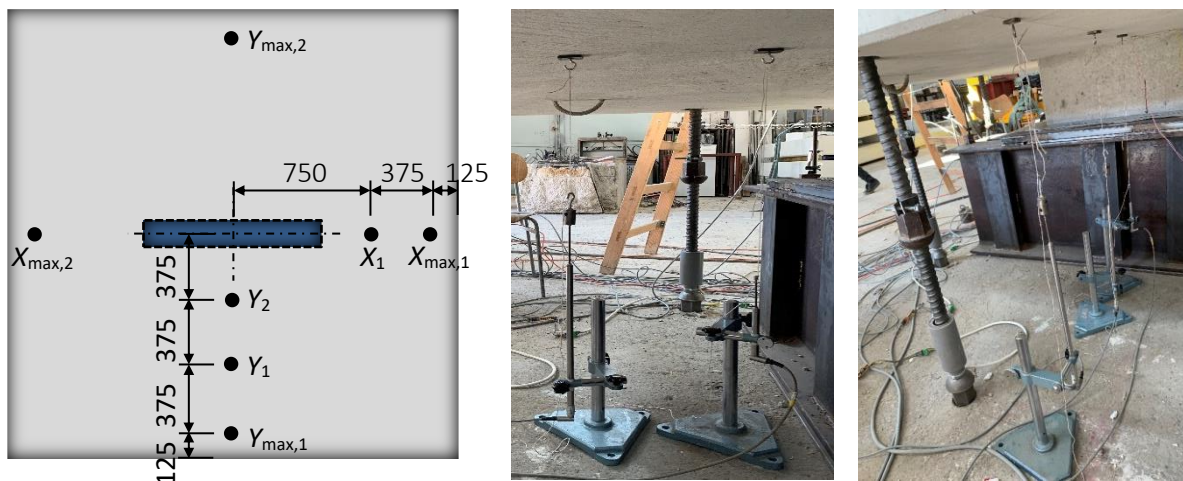
Obr. 5.6 Rozloženie LVDT snímačov pre vzorku S0 (resp. S1-3, S2-i)
