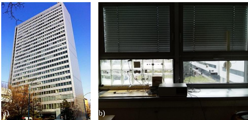
Obr. 8 a) Fotografia juhozápadnej dvojitej prevetrávanej fasády, b) experimentálna zostava sklenených tvaroviek s PCM (vľavo) kombinovaná s polovičnými tvarovkami plnenými vzduchom a konvenčné okno fasády (vpravo)
