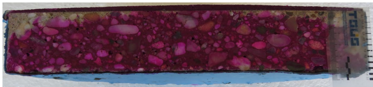
Obr. 4.4: Hĺbka karbonatizácie betónu krytého omietkou EXP 10-39 (vin) [III].
