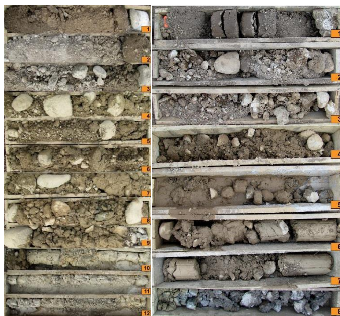
Obrázok 4.3 Fotodokumentácia doplnkového prieskumného vrtu pre rýchlostnú cestu R1 Banská Bystrica – Slovenská Ľupča (Kubiš, 2019)
