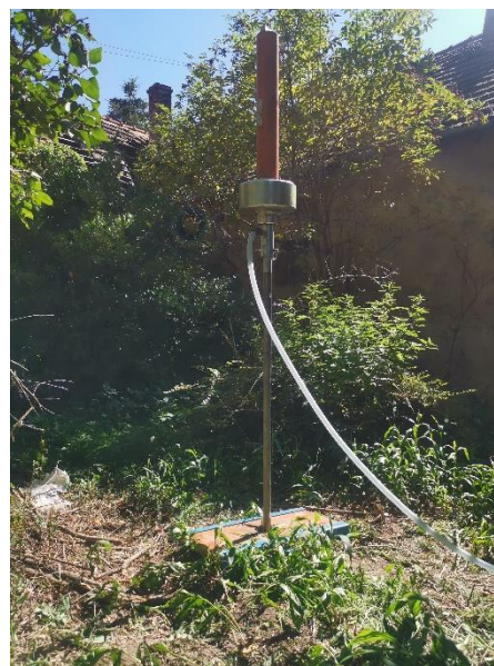
Obrázok 5.1 Dynamická penetračná skúška typu DPM
