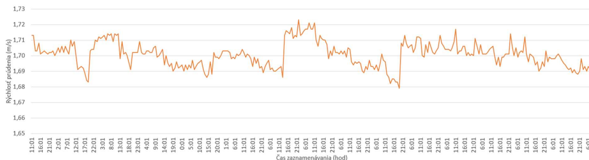
Obrázok 12 Priebeh rýchlosti prúdenia bazénovej vody
