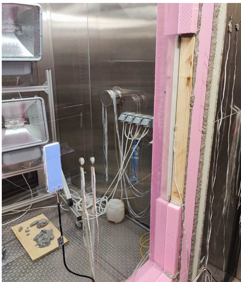
Obr. 4.6 Fragment dreveného hranola a izolácie, poloha doštičky a teplotných senzorov na vnútornej strane
