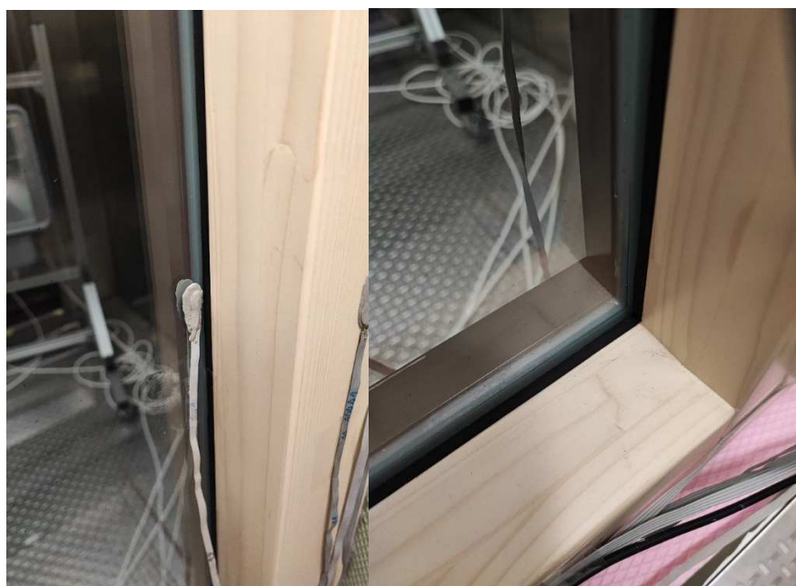
Obr. 4.12 Absencia viditeľnej kondenzácie v styku zasklenia a rámu v rohovom spoji drevo – hliníkového okna pri štvrtom teplotnom scenári
