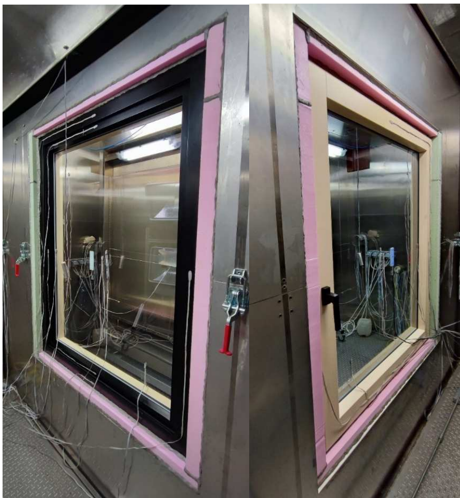
Obr. 4.11 Osadenia prototypu drevo-hliníkového okna zo strany exteriéru (vľavo – studená komora klíma-komory) a interiéru – (vpravo - teplá komora klíma-komory) s teplotnými senzormi a doštičkou na meranie hustoty tepelného toku vákuovým zasklením
