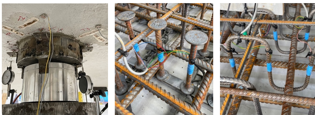
Obrázok 1.10 Tenzometrické snímače na betónovom povrchu a šmykovej výstuži
