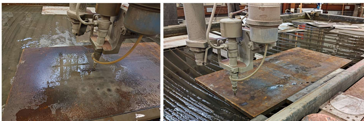
Obr. 5.2 Proces vyrezávania vzoriek z oceľového plechu hrúbky 20 mm
