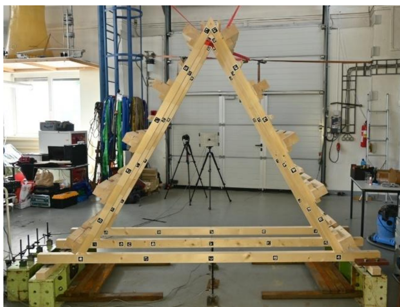
Obrázok 4.3.2 Zostavený nezaťažný experimentálny model - pohľad od priestoru laboratória
