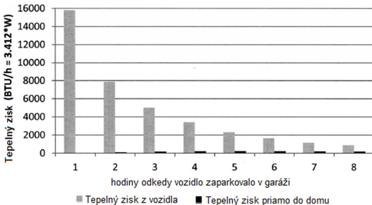
Obr. 2.1 Graf hodinových tepelných ziskov z vozidla v garáži [57] .
