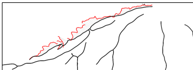
Obr.4-8: Hlavné pretvorenia a kinematika trhlín železobetónových fragmentov z receptúry 4R
