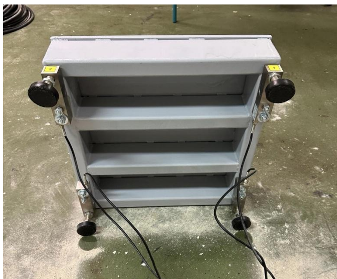
Obr. 2 Zostrojená oceľová konštrukcia s tenzometrickými snímačmi
