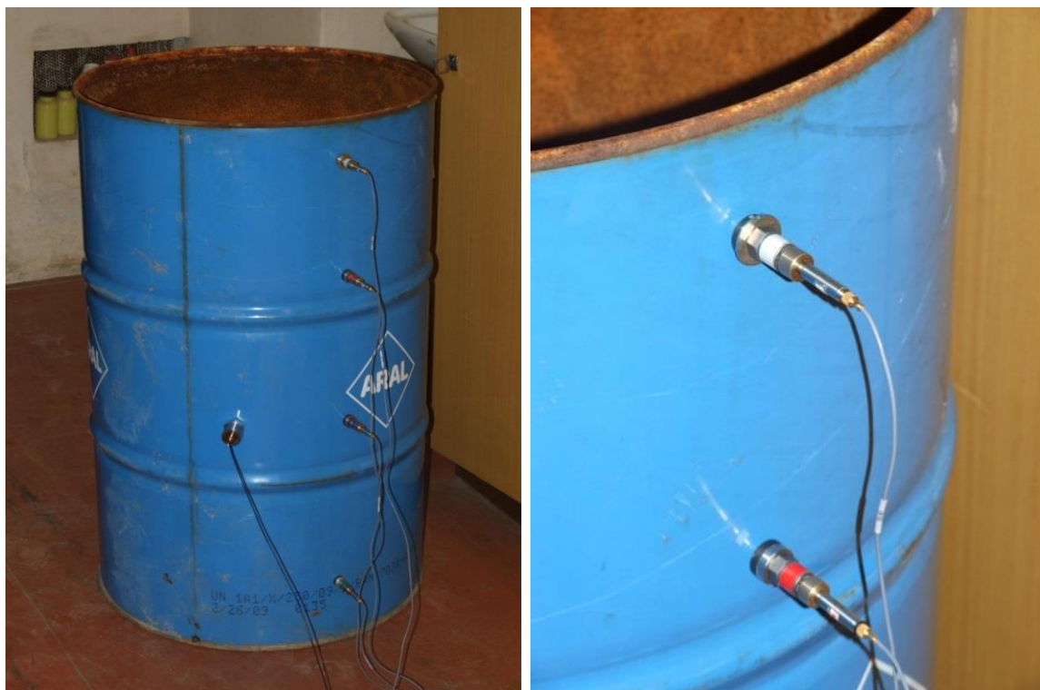
Obr. 5.1 Pripravená vzorka na experimentálne meranie + detail akcelerometra
