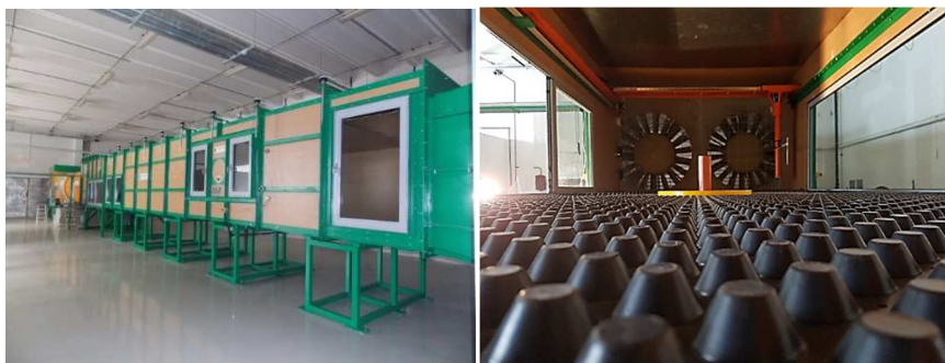
Obr. 6.1 – a) Pohľad na BLWT, b) Interiér tunelu – medzná vrstva
