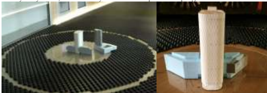
Obr. 17: a) Objekty v tuneli, b) samostatná budova v tuneli
