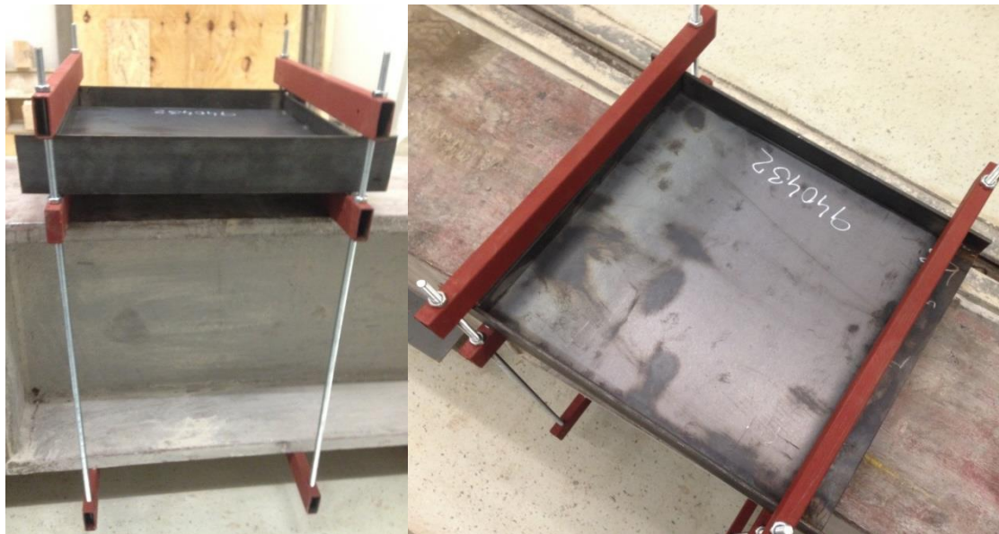
Obr. 9.4 Tenkostenný panel prichytený na mohutný oceľový nosník
