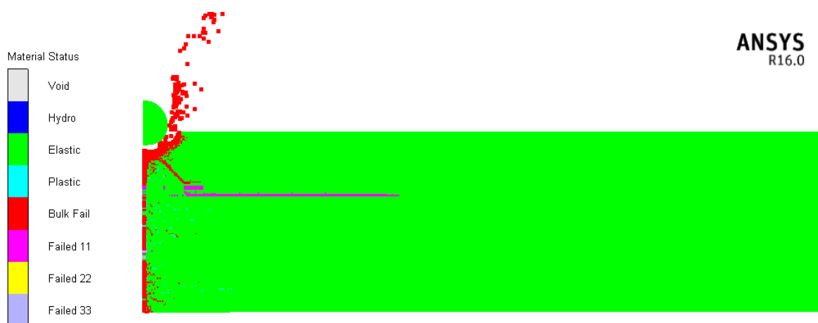
Obr. 21 Porušenie materiálov skla 10.10.10.4.4
