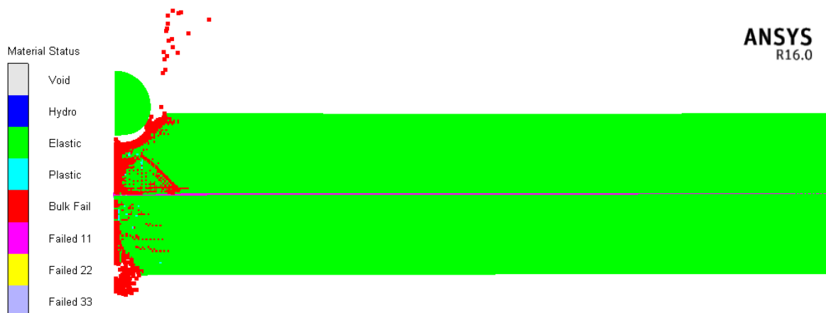
Obr. 17 Porušenie materiálov skla 10.10.1
