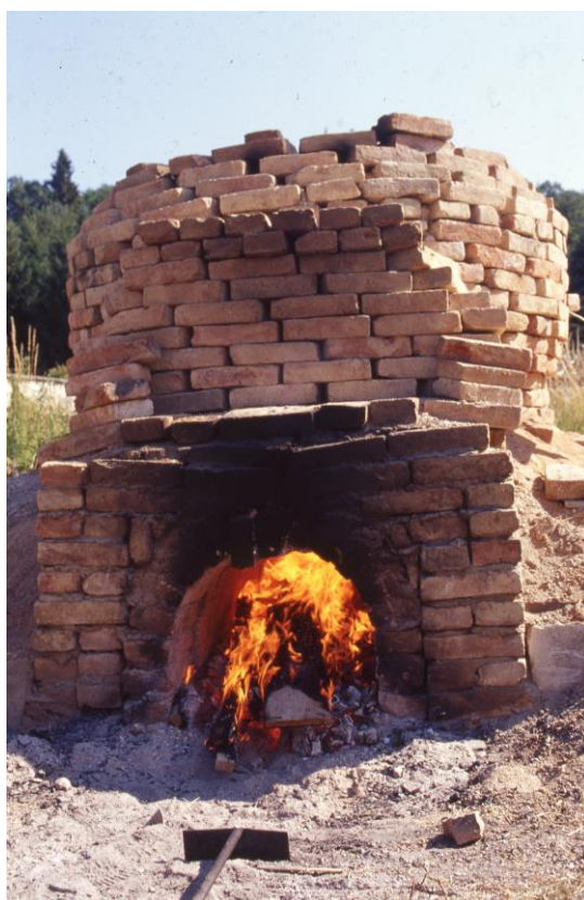
Obr. 4-4-1. Pec na experimentálne pálenie vápna rímskeho typu s dlhším ohniskovým kanálom.
