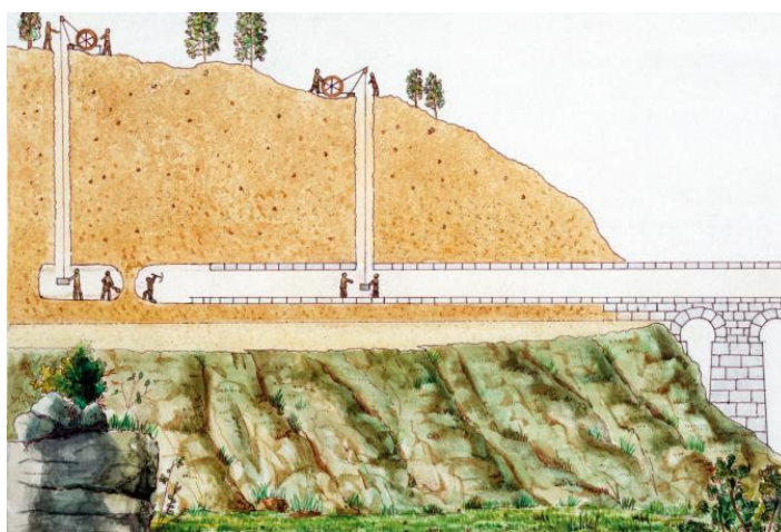
Obr. 5-5-1. Schematické znázornenie kopania rímskeho tunela. Vidno aj vertikálne šachty využité ako na dopravu výkopku z tunela von, tak aj na vetranie tunela [ https://www.nationalgeographic.com ].
