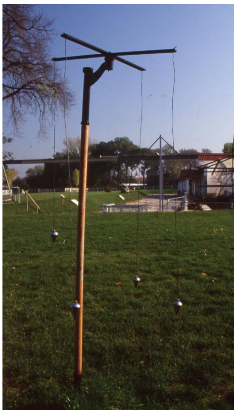
Obr. 6-3-1. Replika zameriavacieho prístroja groma v Carnunte.
