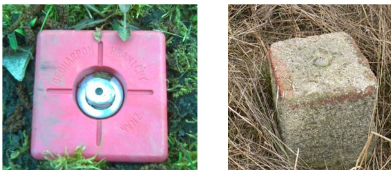
Obr. 2.3. Príklad trvalej stabilizácie bodu PBPP.
