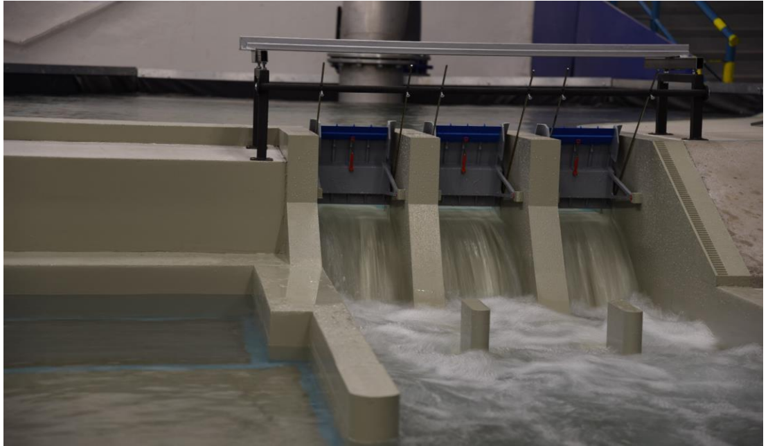
Obr. 3.22 Prúdenie vody v oblasti hate VD Žilina na fyzikálnom modeli v hydrotechnickom laboratóriu Katedry hydrotechniky Stavebnej fakulty STU v Bratislave (Zdroj: archív autora)
