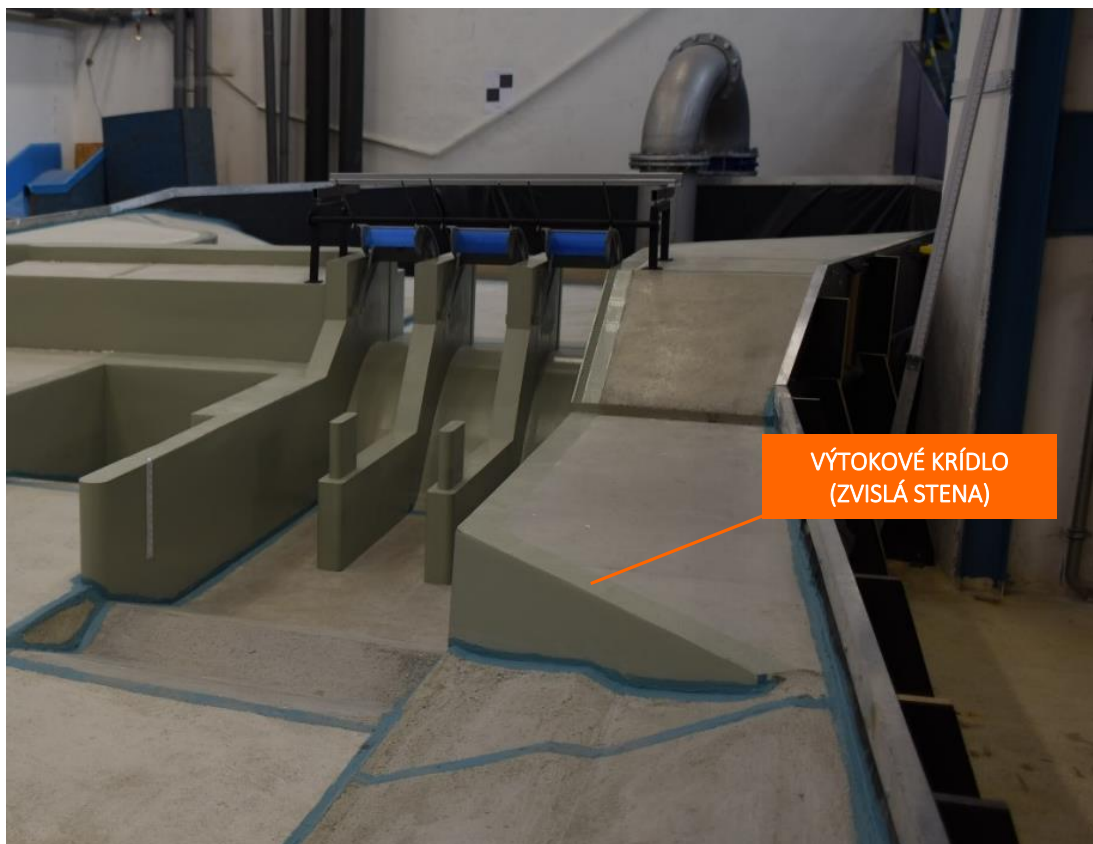
Obr. 4.23 Zvislá plocha výtokového krídla na hati VD Žilina – fyzikálny model v hydrotechnickom laboratóriu Katedry hydrotechniky Stavebnej fakulty STU v Bratislave (Zdroj: archív autora)
