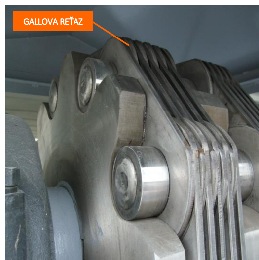
Obr. 8.54 Trojložná Gallova reťaz (Zdroj: mr-retaze.sk)
