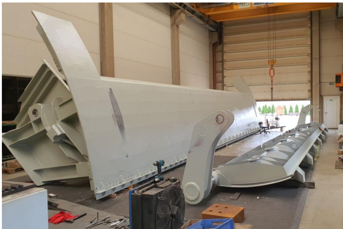
Obr. 8.91 „Balený“ segment s nasadenou klapkou s celkovou hradiacou výškou 3,2 m a šírkou 16 m – rekonštrukcia hate Hranice na Bečve, ČR (Zdroj: ČVUT Praha, © Petr Valenta)
