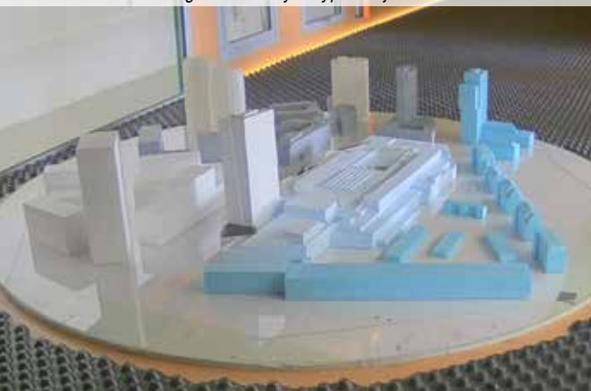
Testovanie konfigurácie rôznych typov objektov vo veternom tuneli
