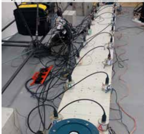
Dynamické meranie kompozitného nosníka
