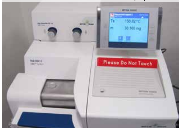
Meranie zmien hmotnosti v závislosti od zmien teploty
