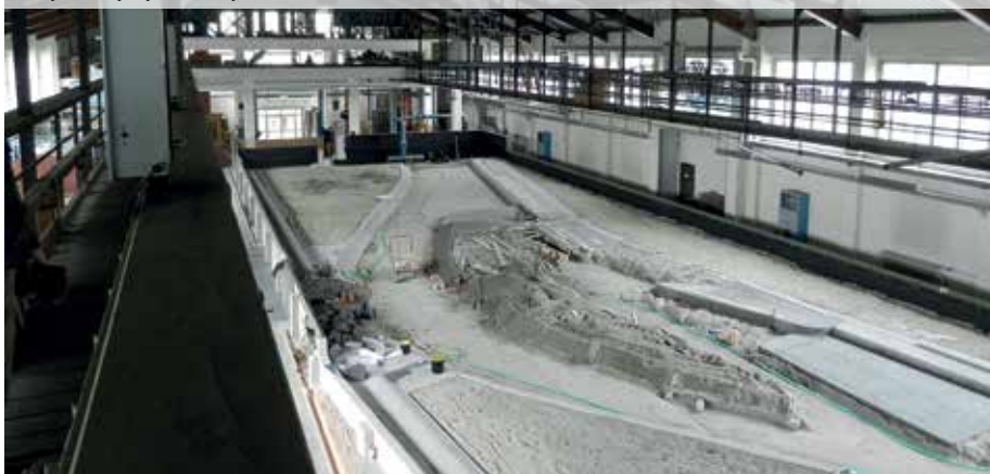
Fyzikálny hydraulický model Vodného diela Kolárovo
