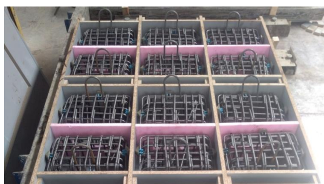
Obr. 5.2 Výstužný kôš pripojených blokov a príprava betonáže vzoriek 2. série
