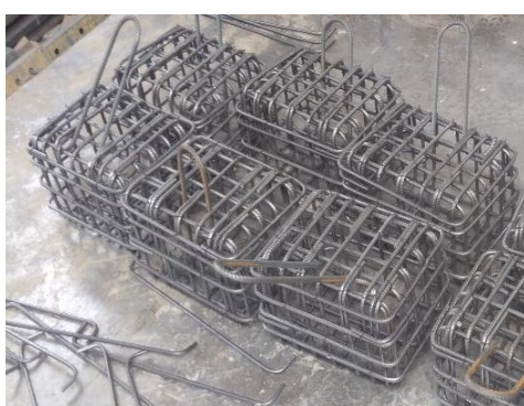
Obr. 5.2 Výstužný kôš pripojených blokov a príprava betonáže vzoriek 2. série
