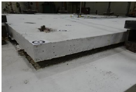
Obr. 4 Odlepenie nadbetonávky od pôvodnej dosky
