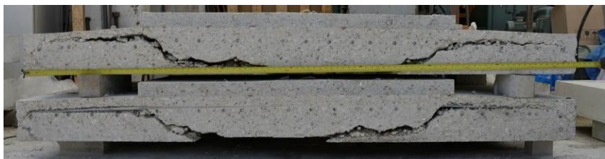
Obr. 5 Zlyhanie zosilnenej dosky s nadbetonávkou nedostatočnej veľkosti
