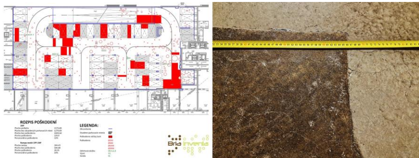
Akousi samostatnou časťou sú prieskumy podláh – zvyčajne v hromadných garážach. Často je predmetom zisťovania delaminácia nášľapnej vrstvy a korózia výstuže v stropných doskách. Pre delamináciu je kľúčové určiť rozsah poškodenia (vo vzťahu k STN 74 4505). Pasportizáciu robíme akustickým trasovaním. Z hľadiska rizika korózie výstuže overujeme v spolupráci s TSÚS obsah chloridov.
