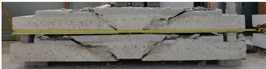
Obr. 6 Zlyhanie zosilnenej dosky s nadbetónávkou dostatočnej veľkosti
