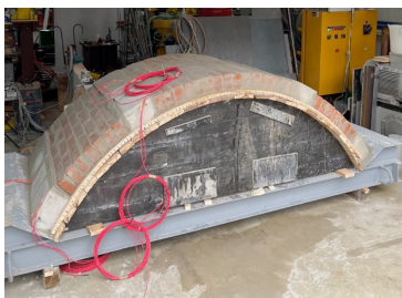
b) Vymurovaná tehlová klenba
