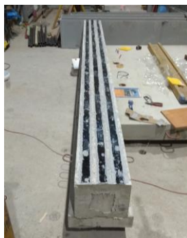
b) Nosník C – lepenie lamíel
