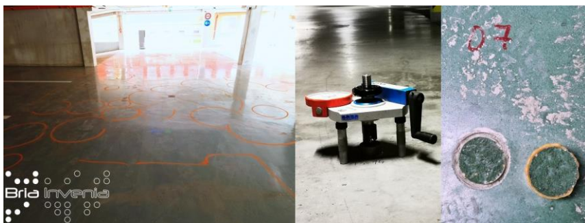
Obr. 7: Čiastočne deštruktívne zásahy – pre určenie prídržnosti
