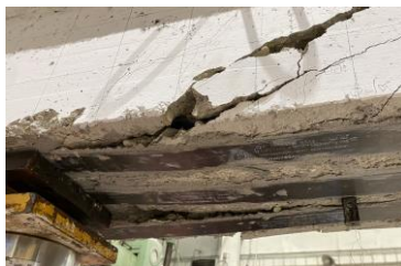
Obr. 6 Šmykové porušenie nosníka C
