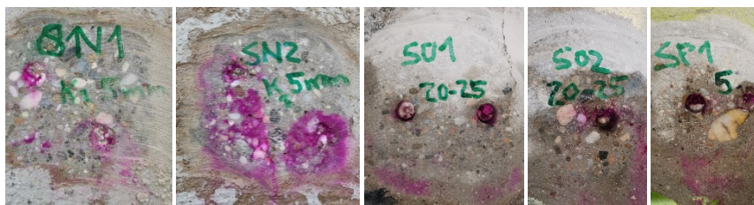
Obrázok 3.1: Hĺbka karbonatizácie betónu.
