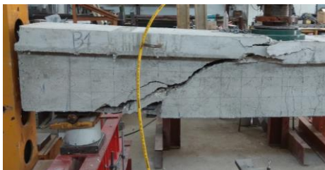
Obr. 5 Porušenie nosníka v polohe B1
