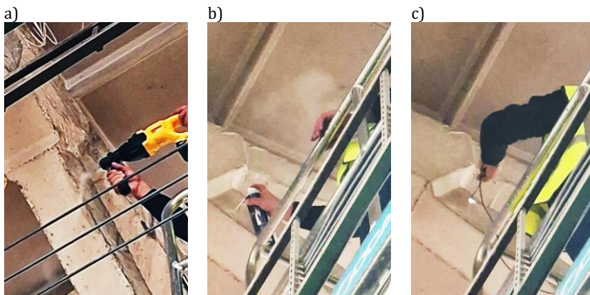
Obr.3: Endoskopia spínaných väzníkov: a) vŕtanie, b)čistenie stlačeným vzduchom, c) kontrola endoskopom
