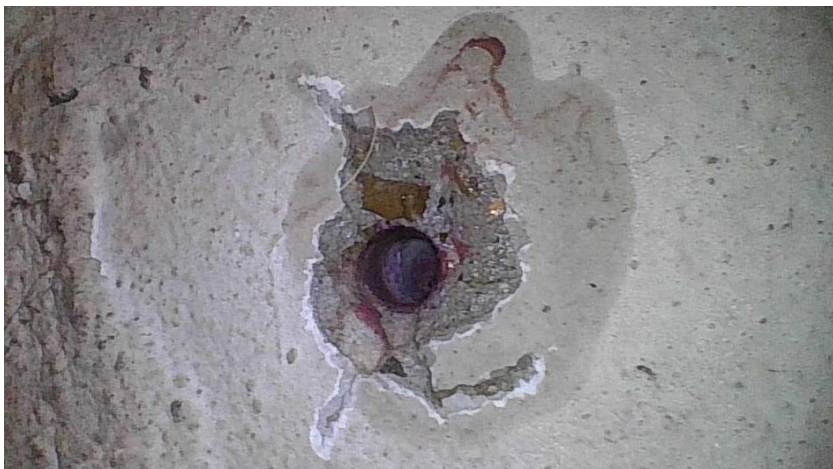
Obr.10: Aplikácia fenoltaleínu v mieste vrtu pre endoskop – hĺbka karbonatácie 2-3 mm
