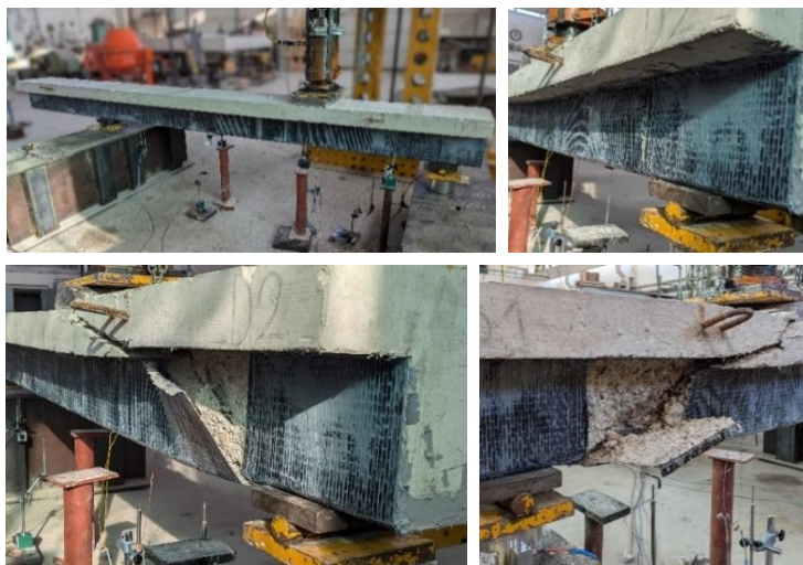
Obr. 4 Skúška nosníka D (vľavo hore – nosník v zostave, vpravo hore – čiastočná delaminácia tkaniny, dole – delaminovaná tkanina a šmyková trhlina)
