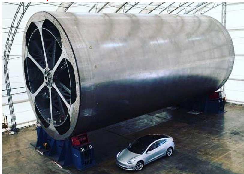
Časť rakety BFR ktorá poletí na Mars, \Phi = 9 m
