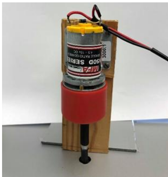
Obr. 10 Elektromotorček s prevodom 1:3000
