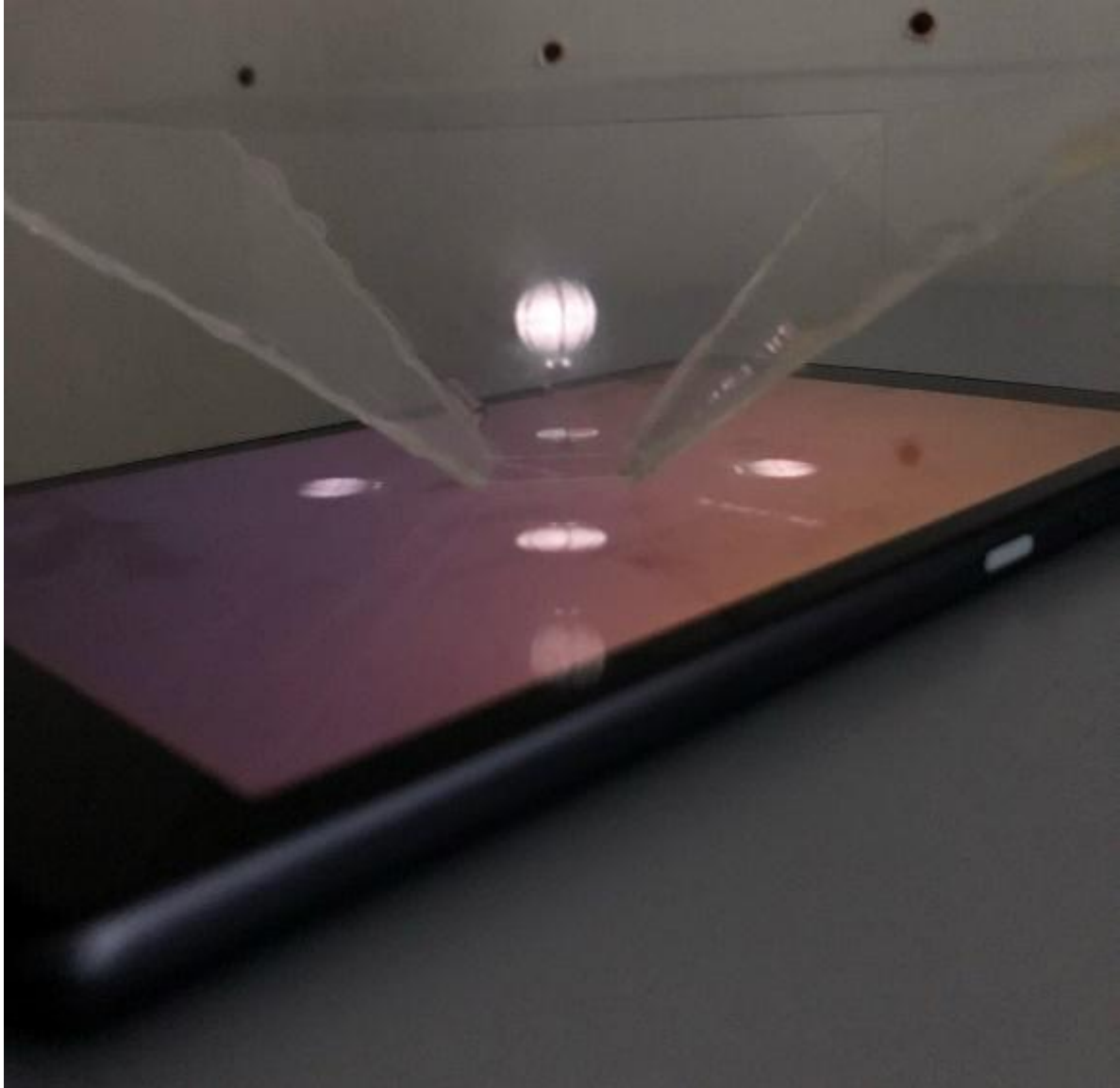
Obr. 22 Projekcia hologramu pomocou ihlana a tabletu
