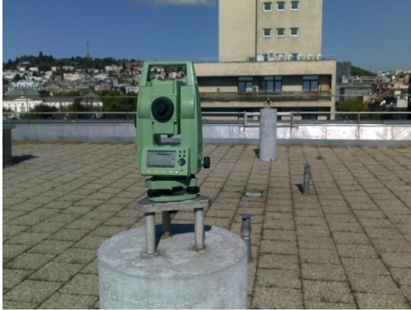
Obr. 2 : Určenie hodnôt dĺžky univerzálnou meracou stanicou Leica TCR 407[2]
