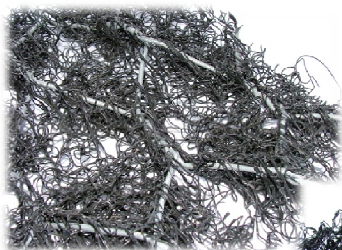
Geokompozit s výstužou s dvojjákrutovej ocel'ovej siete
