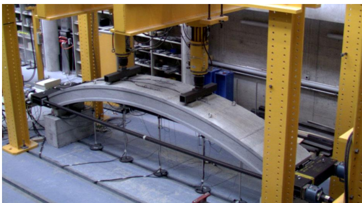
Obr. 8: Skúška tunelového segmentu o reálnych rozmeroch
