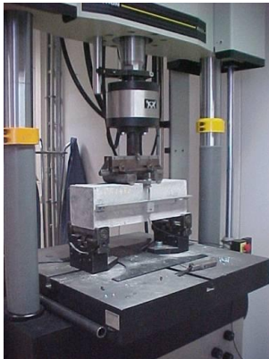
Obr. 5: Skúška pre 4 bodový ohyb
