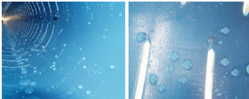
Bild 16: Innenseite nach 30 Spülgängen: links Längsriefen, rechts Schlitzende
