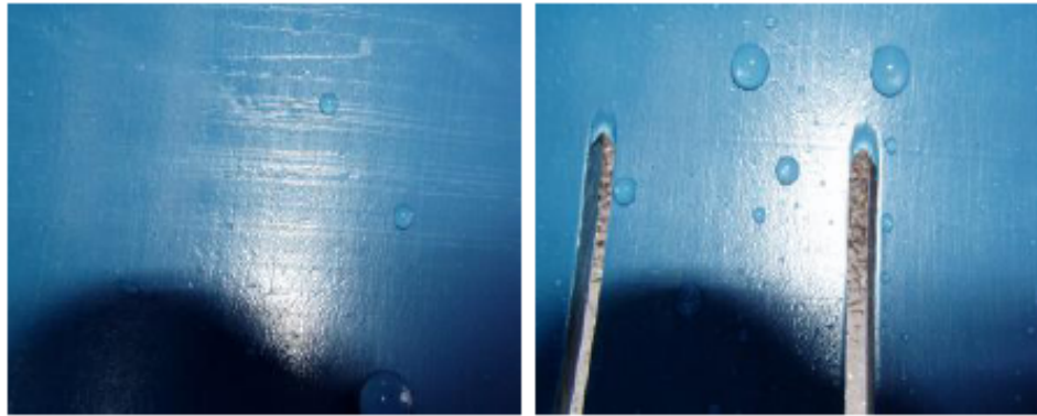
Bild 14: Innenseite nach 10 Spülgängen: links Längsriefen, rechts Schlitzende
