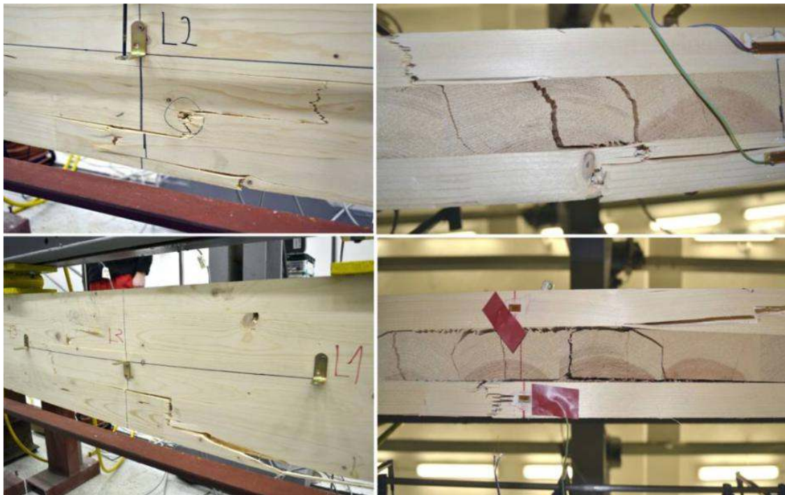
Obr. 10 - Spôsob porušenia vzorky A1, h=0,3 m
