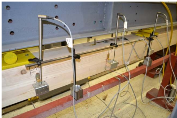
Obr. 13 - Indukčné merače deformácií a tenzometre
