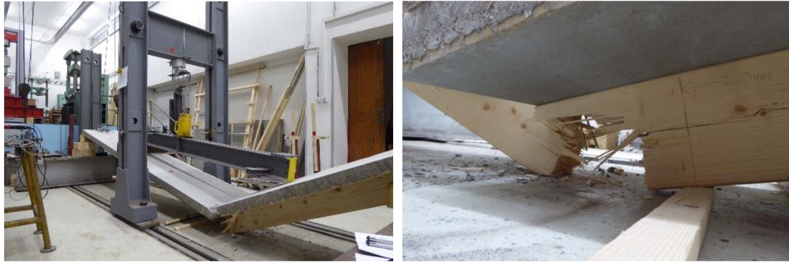
Obr. 7 - Porušená vzorka (vľavo) a detail porušenia (vpravo)
