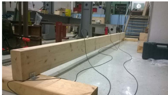
Obr.5 - Skúšobná zostava pre meranie vlastných frekvencií drevených trávov
