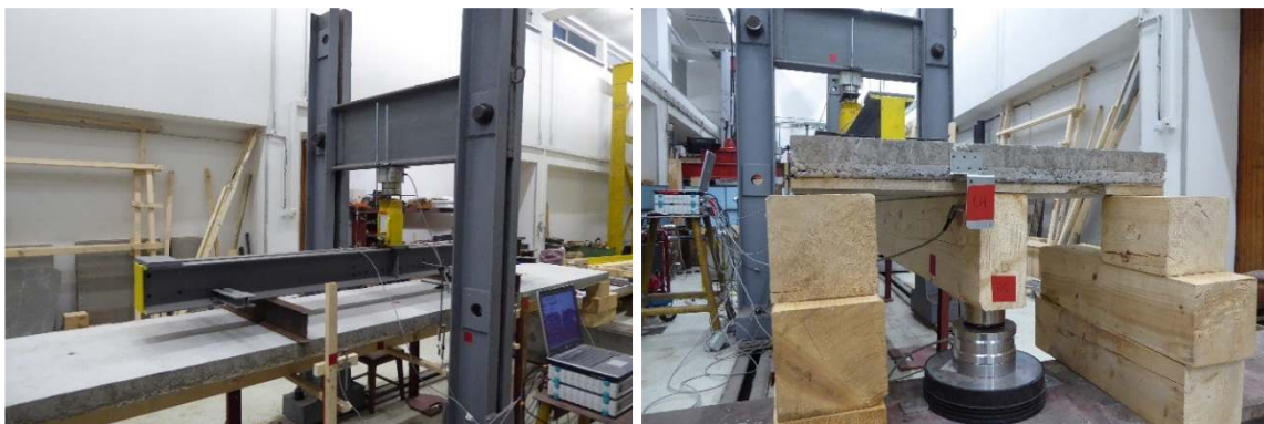
Obr. 6 - Celková zaťažovacia zostava (vľavo) a uloženie v podpere (vpravo)
