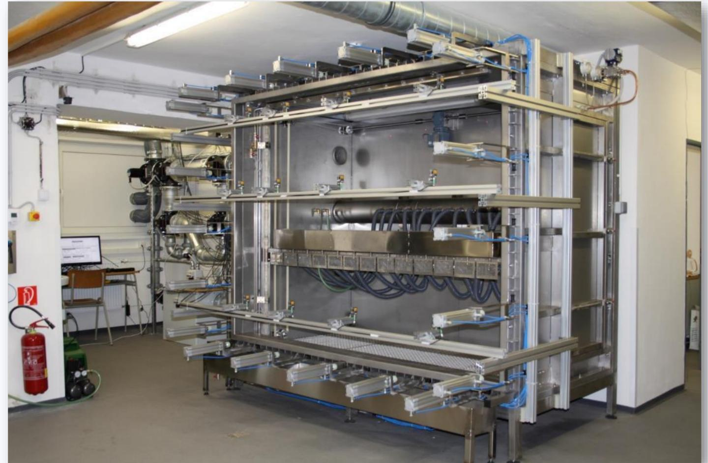
Blick auf große Regenkammer für die Modellierung von komplexen Effekten von windgetriebenem Regen
