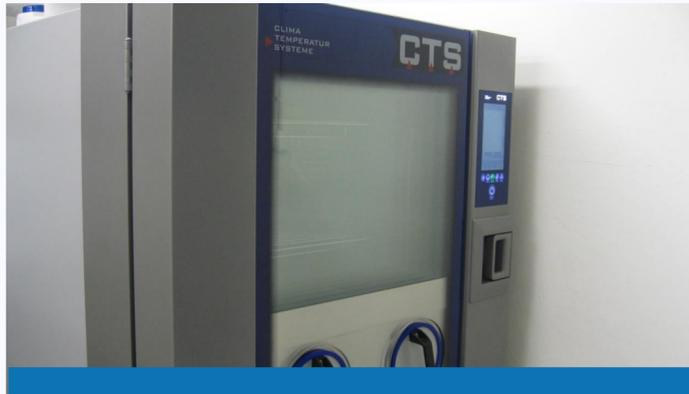
**Testkammern für Sonnenlicht- und Feuchtigkeitssimulation**
