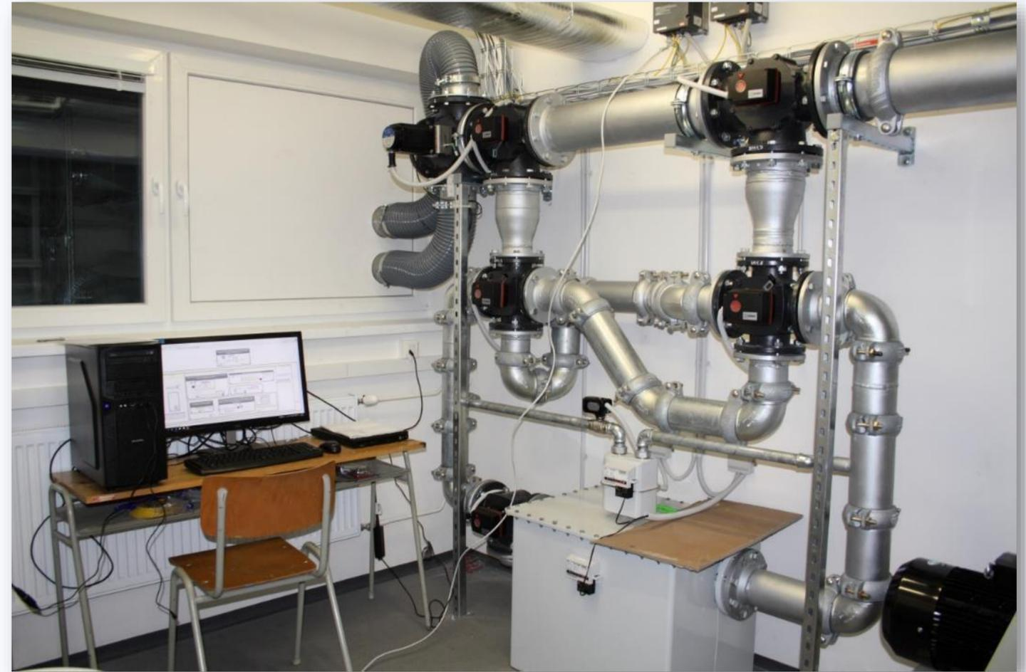
Blick in den technologischen Bereich der großen Regenkammer für die Modellierung von komplexen Effekten von windgetriebenem Regen
