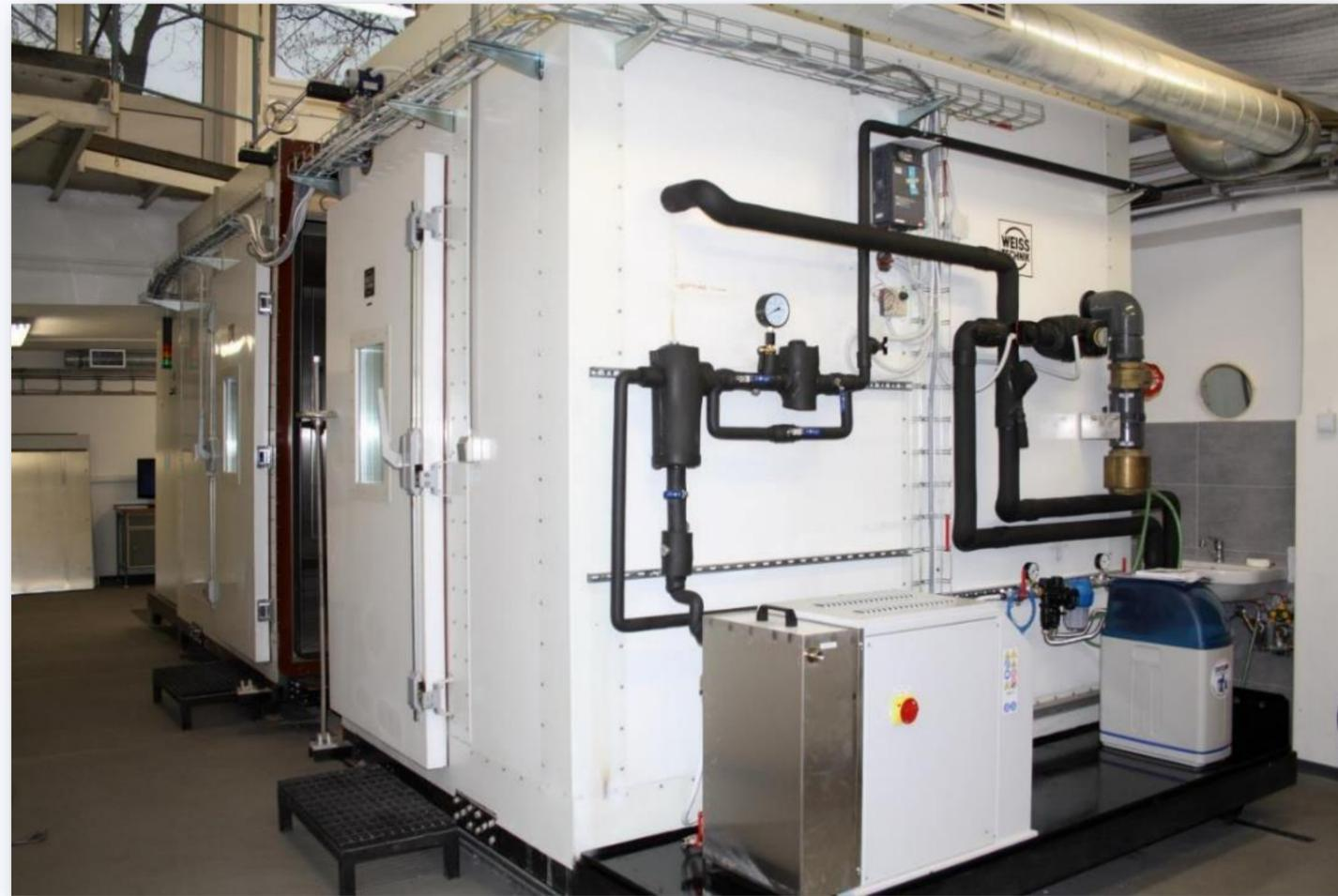
Blick auf die große Klimakammer für die Simulation von synergistischen Vorgängen der Wärmeübertragung, Wasserdampfdiffusion und Luftfiltration.
