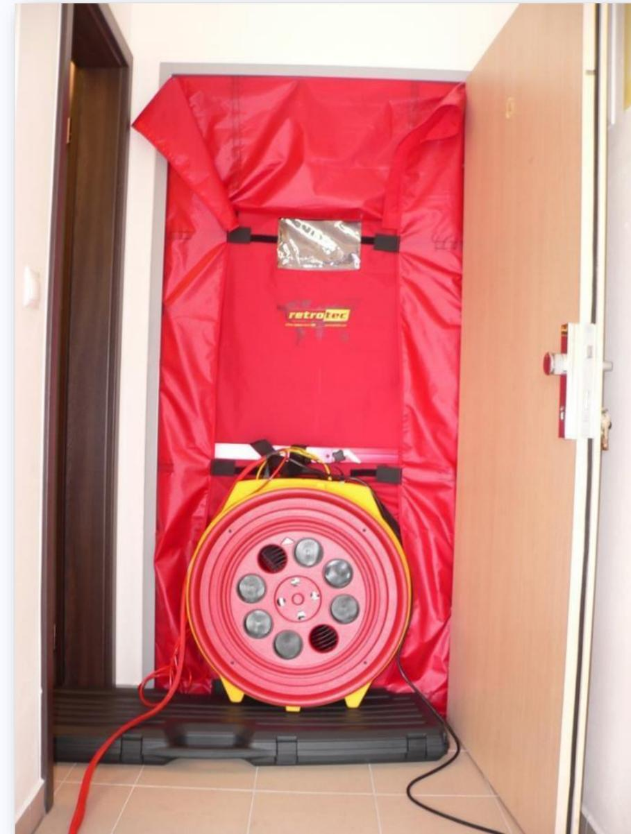
Beispiel für RETROTEC Q46-240V Verwendung bei der Messung von Lecks in einem Mehrfamilienhaus
