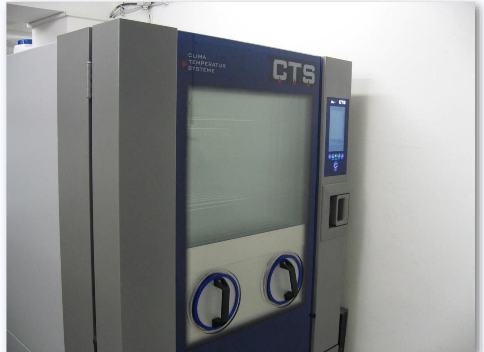
Blick auf die Glastür der Testkammer und zwei Handschuhöffnungen für die Handhabung der Testproben
