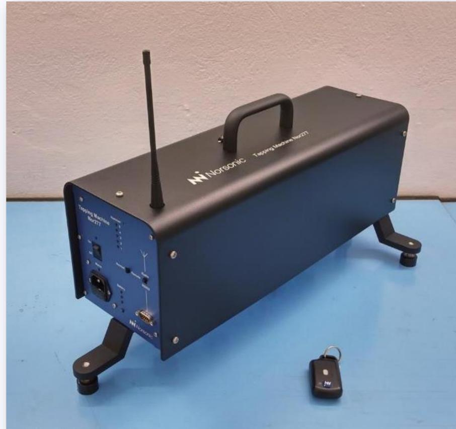
Normhammerwerk Nor227 mit Fernbedienung
