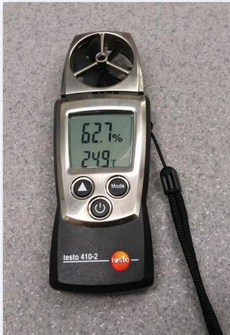
Es handelt sich um ein Flügelrad-Anemometer mit integrierter Feuchtemessung und NTC-Sensor zur Messung von Lufttemperatur, inklusive Schutzkappe, Batterien und Kalibrierprotokoll.
