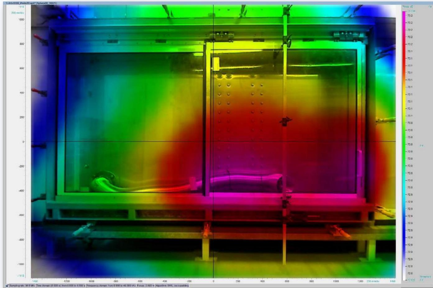
Abbild vom akustischen Feld von einer Probe am verglasten Balkon im Frequenzbereich von 20 Hz bis 20 kHz
