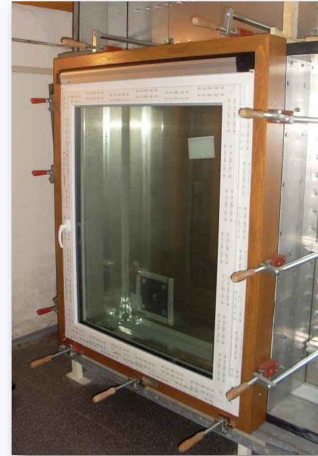
Blick auf Fenster mit Lüftungsgitter installiert in der großen Druckkammer
