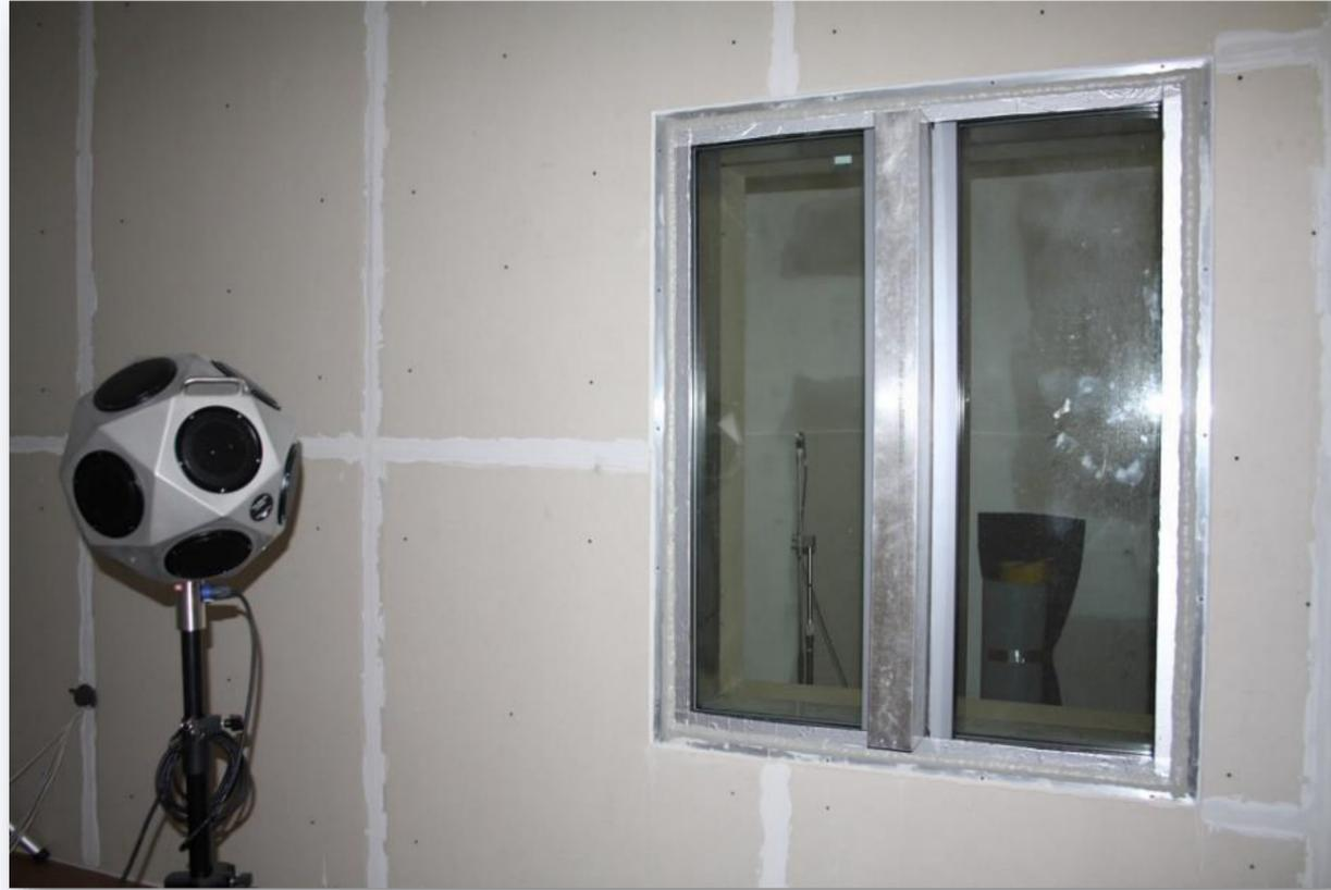
Der Innenraum der Übertragungskammer mit dem Lautsprechersystem Brüel & Kjaer Typ 4292-L. In der Test-Öffnung wird die Luftschalldämmung von einem Aluminiumfenster mit einem vertikal positionierten akustischen Lüftungsgitter gemessen.
