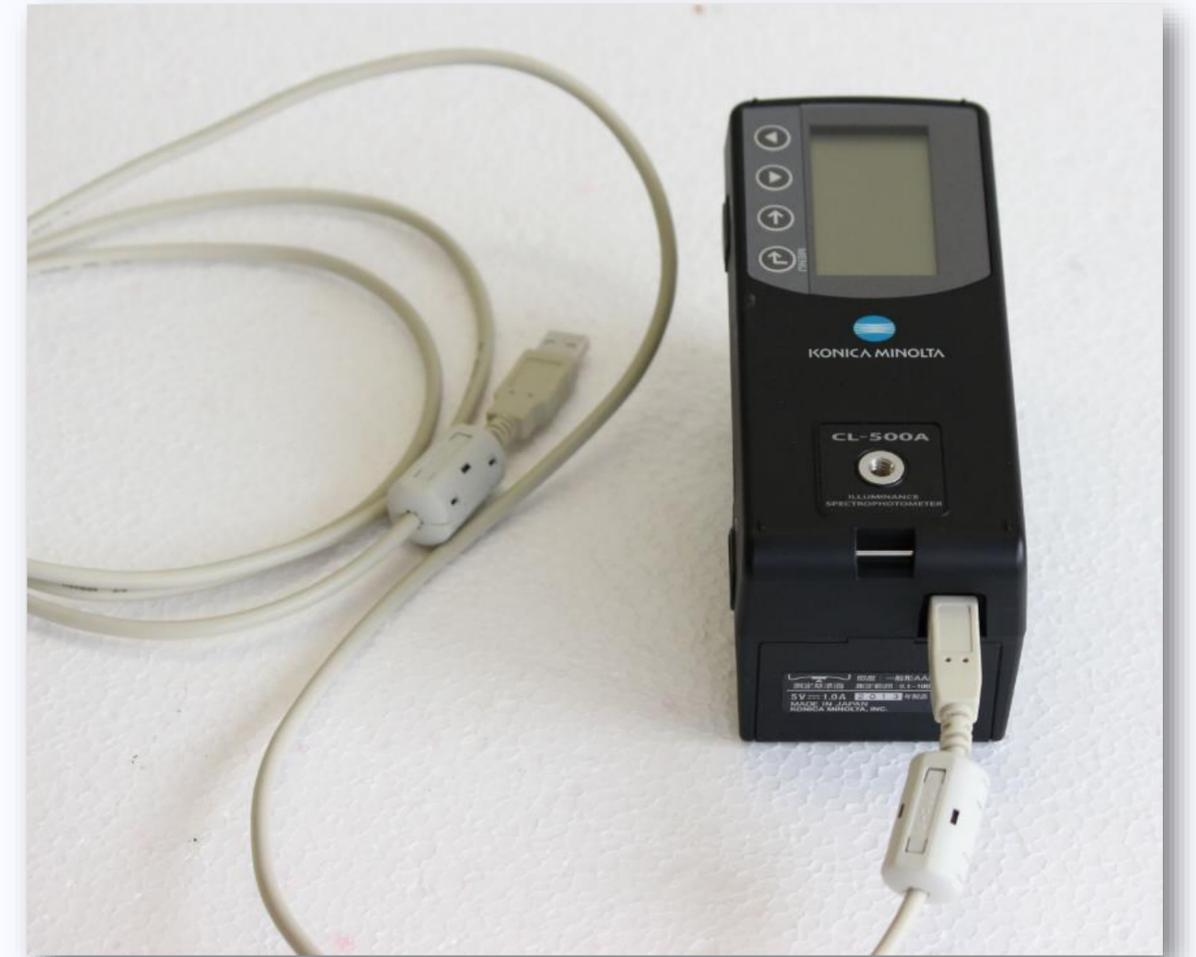
Spektralphotometer Konica Minolta CL-500A mit Verbindungskabel zum PC
