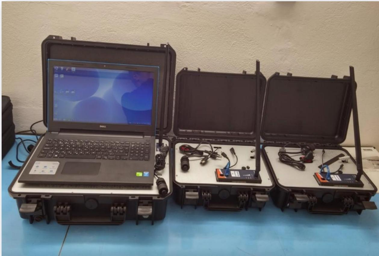
Kabelloses Übertragungssystem von Messdaten und Messprozesssteuerung der Messung von bauakustischen Eigenschaften über einen PC
