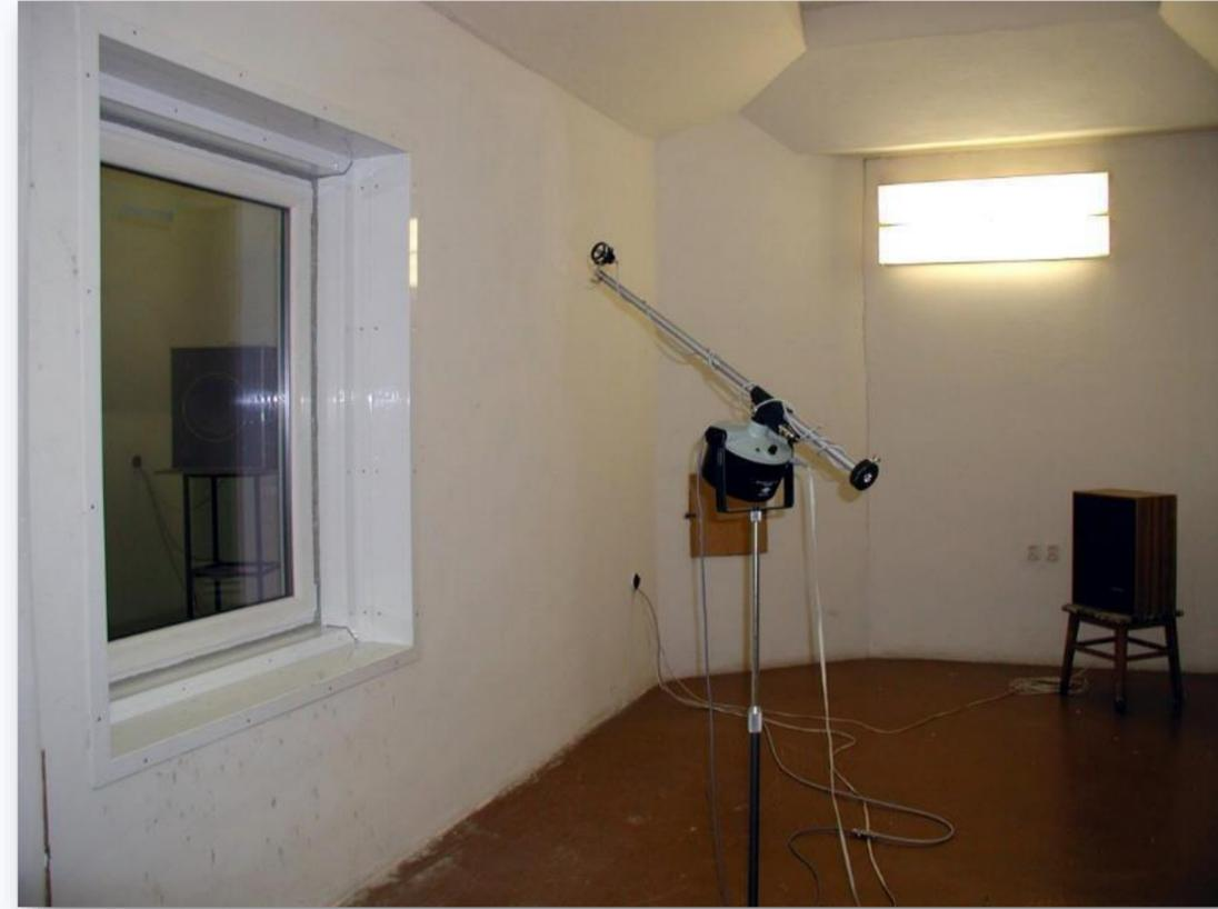
Der Innenraum der Aufnahmekammer, die Test-Öffnung ist mit einem Doppel-Kunststoff-Fenster ausgestattet.
