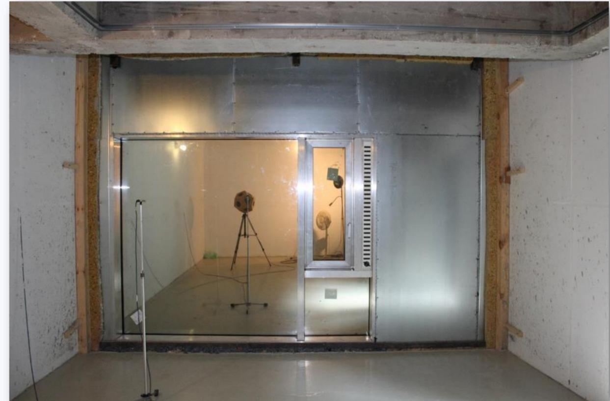
Fassadenelement angebracht im Maskierpanel in Akustikkammern
