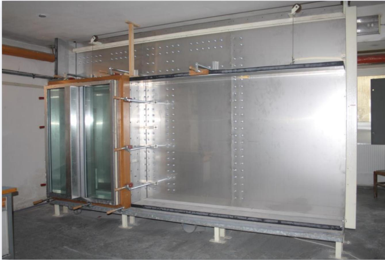
Blick auf die große Druckkammer für die Forschung von Luftinfiltration durch Details oder Komponenten (Fenster, Glaswände) der Gebäudehülle
