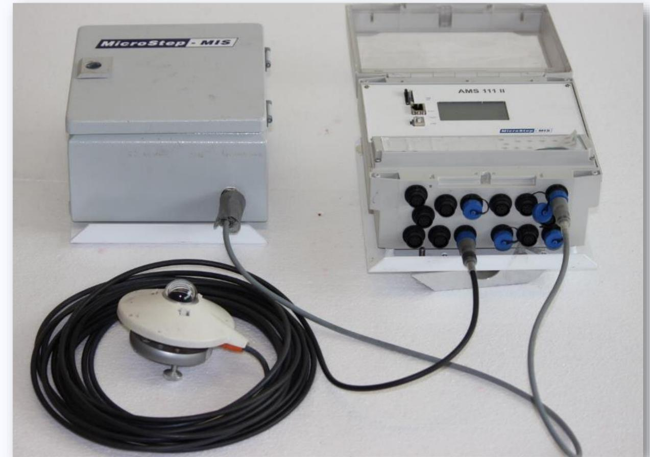
Pyranometer CMP3 mit Batterie und Wetterstation AMS II
