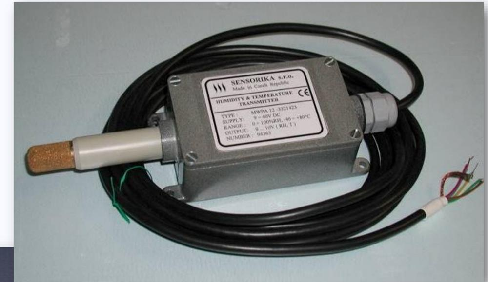
Sonde zur Messung der relativen Luftfeuchte Sensorika HP-1212420
